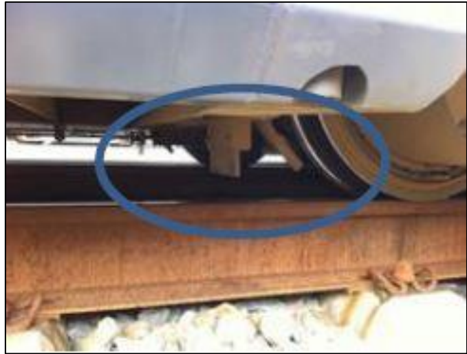
Figur 11: Skinnerydder foran hjul. Kilde: Keolis Norge AS
