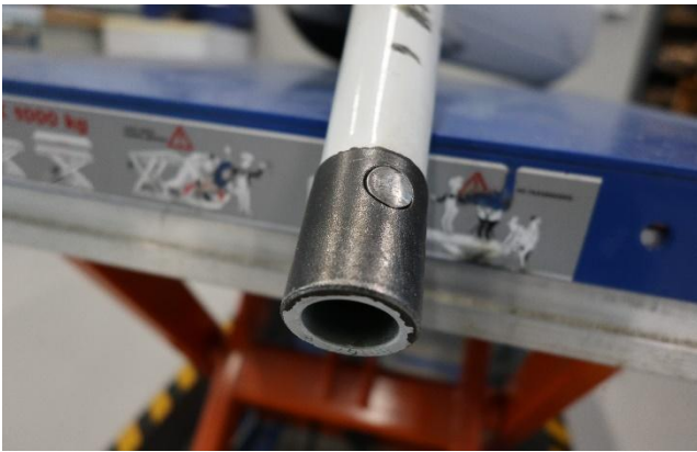
Figur 4: Stag til høyre understell med klipt festebolt. Foto: SHK
