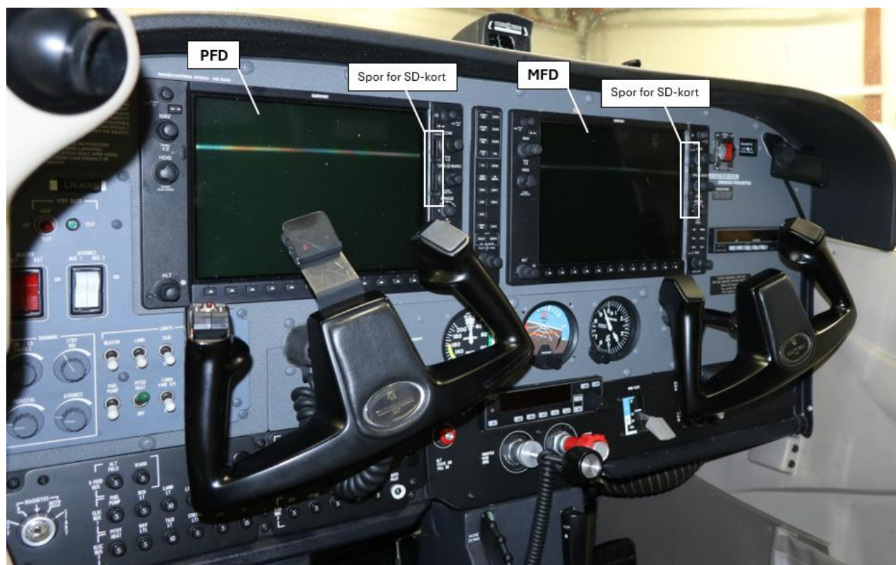
Figur 10: Cockpiten i LN-KAB med Garmin G1000 installert. Spor for SD-kort er markert med hvit firkant på PFD og MFD. Foto og illustrasjon: SHK
