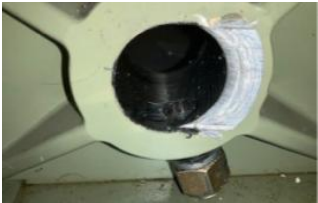
Figur 5: Innfesting høyre understell med klipt festebolt. Foto: Norrønafly Rakkestad AS
