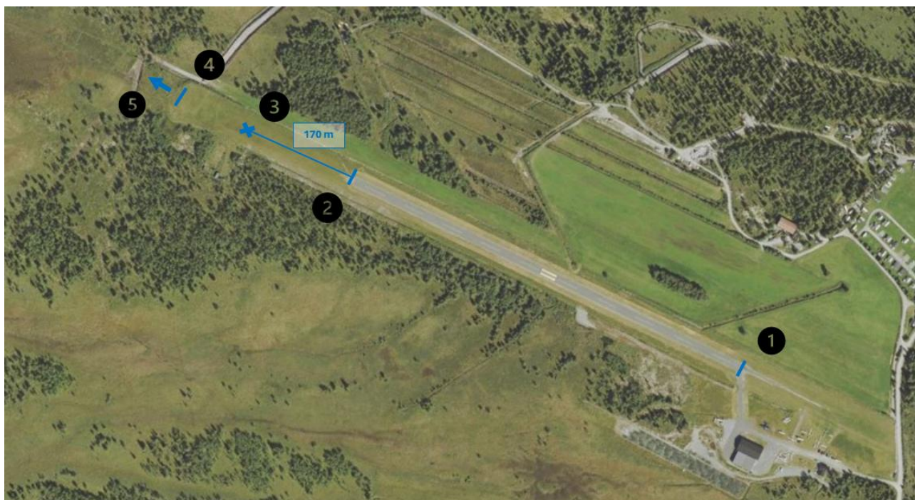
Figur 1: Gol flyplass Klanten med 1) startpunkt for avgangen, 2) enden på rullebanens asfalterte del, 3) anslått første setningspunkt for LN-KAB, 4) rullebanens ende og 5) omtrentlig havaristed for LN-KAB. Foto: © Norgeskart Illustrasjon: SHK
