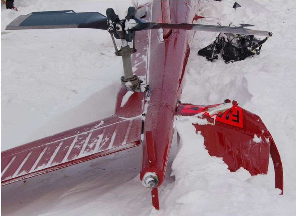
Figur 7: Halerotor, vertikale haleflater og halerotorbeskytter (tail guard). Instrumentpanelet ligger i snøen ved halebommen.
