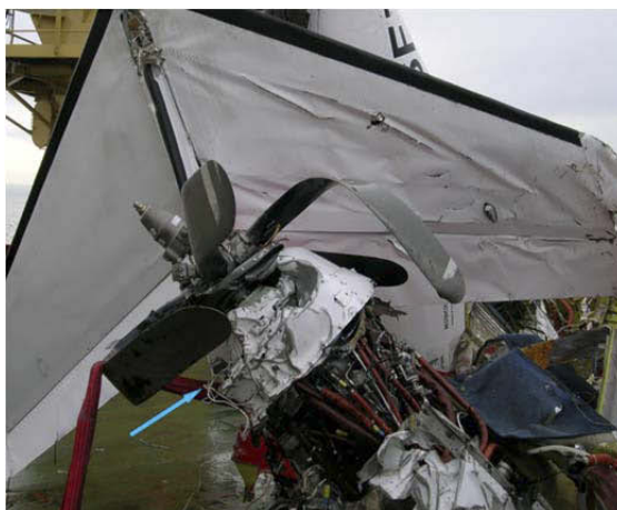
Figur 10: Høyre motor og haleflaten sett ovenfra. Pilen peker mot et område på undersiden av motoren hvor vanntrykket har formet platehuden inntil strukturen bak platen.
