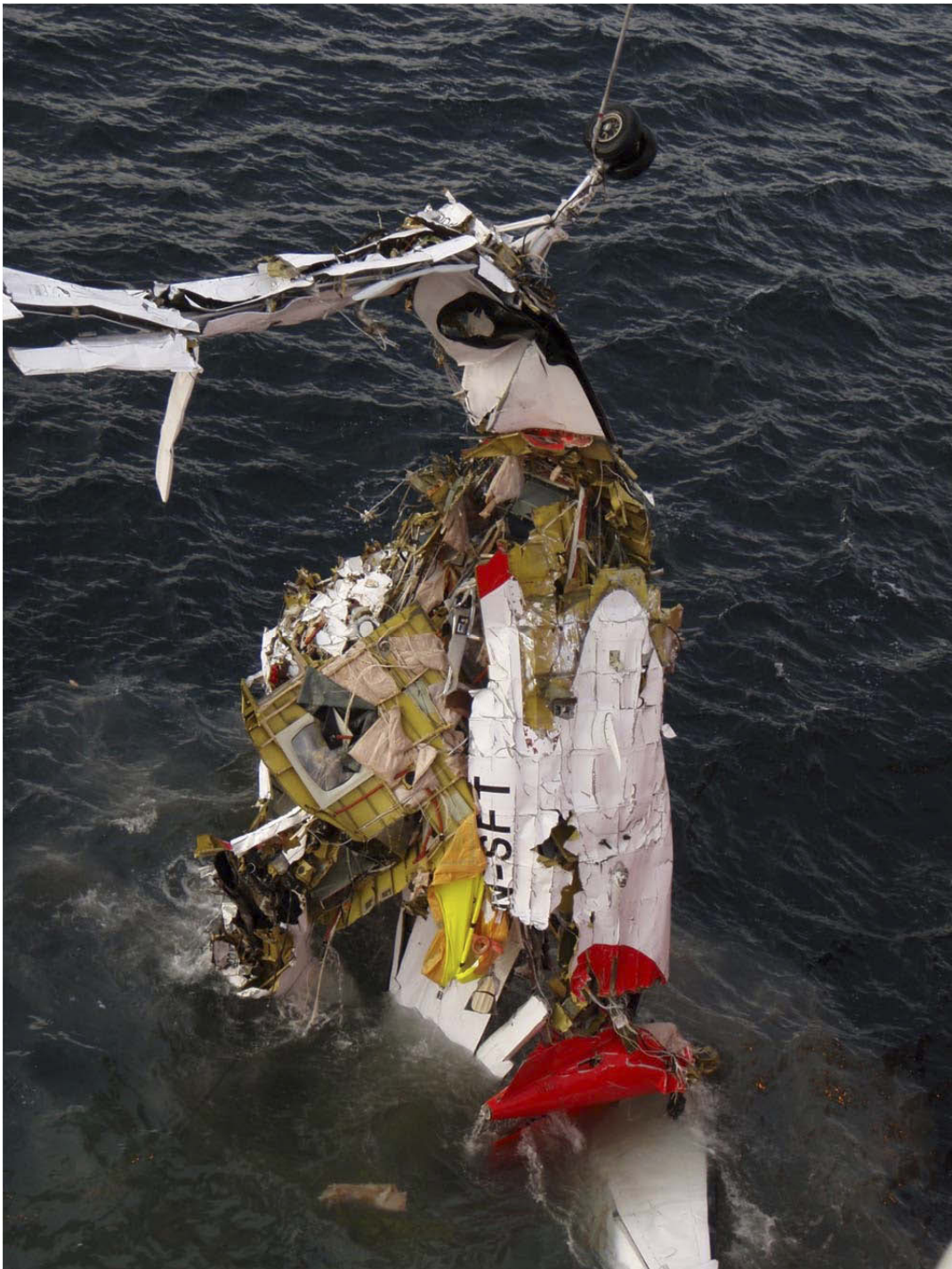
Figur 6: Flyvraket heves ut av sjøen. Bøyningen av høyre vinge og skadene på undersiden av flyskroget (hvitt felt til høyre for bokstavene LN-SFT) grunnet anslag mot sjøen sees tydelig.
