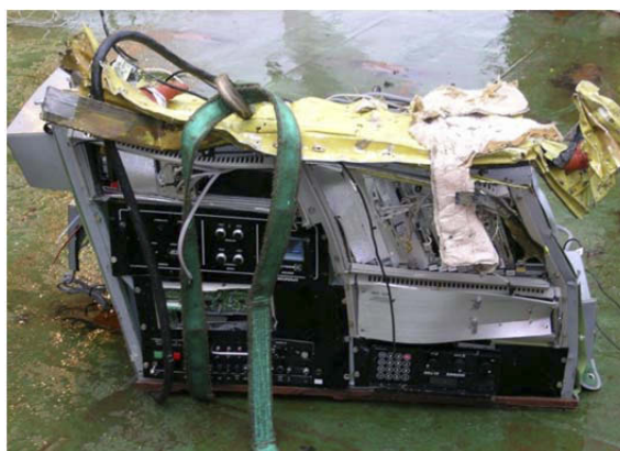
Figur 13: Et kabinett med elektronisk utstyr trykket ned og forover av G-krefter (reolen ligger opp-ned).
