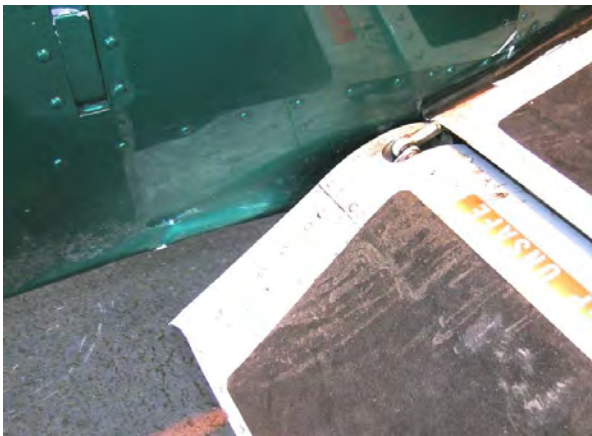
Figur 5: Skader på skroget etter kontakt med flapsen. Foto alle fire bilder: SHT
