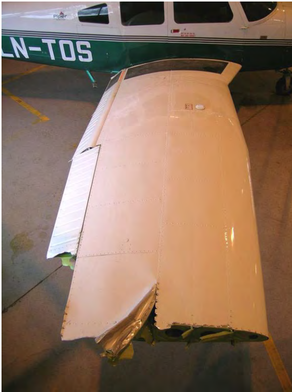
Figur 3: Skader på høyre vinge.
