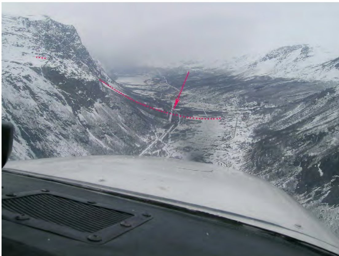
Figur 1: Kabelbanen og antatt treffpunkt avmerket på et bilde tatt mot nord fra en høyde på ca. 1500 ft. Bilde er tatt dagen etter at kollisjonen skjedde. Foto: SHT
