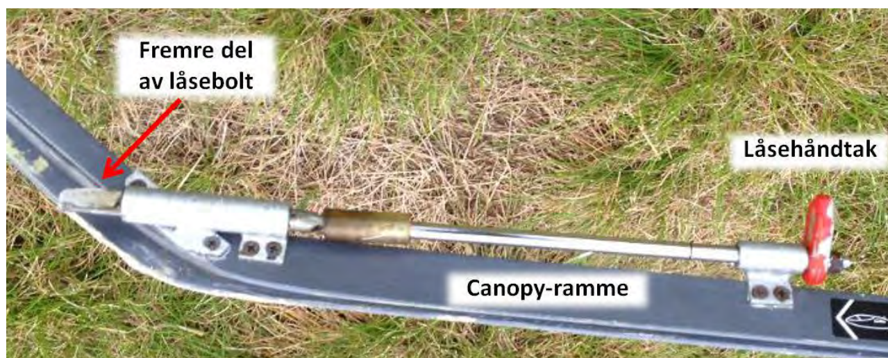
Figur 3: Låsebolt montert på canopy-ramme. Foto: Elverum flyklubb
