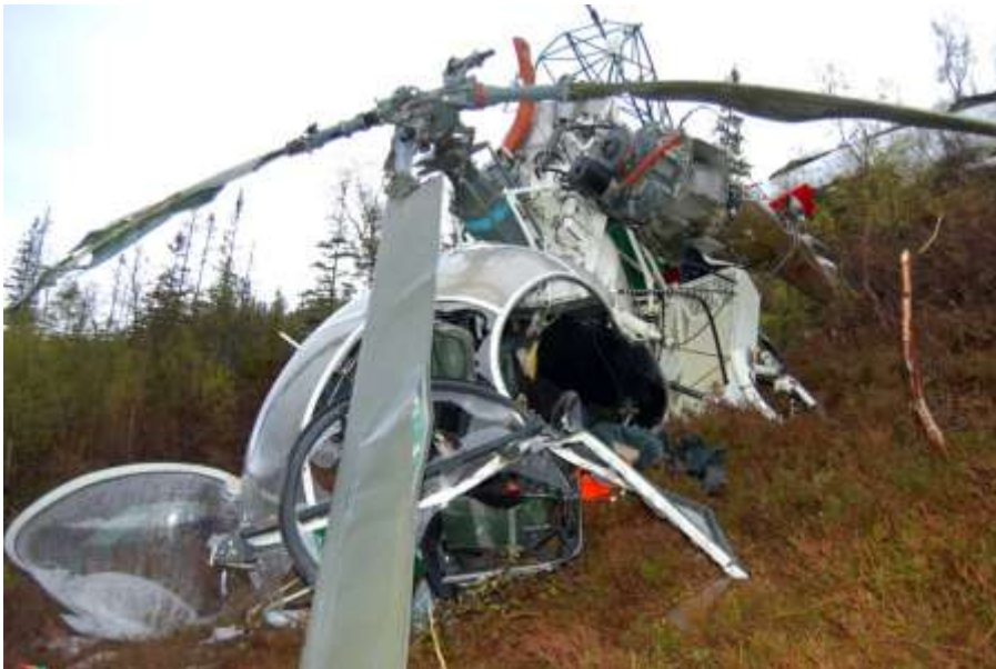
Figur 5: Viser skader på cockpit og helikopteret forøvrig. Foto: SHT
