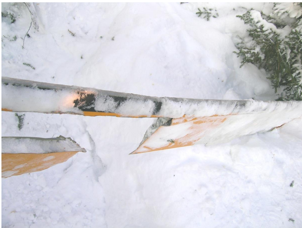
Figur 6: Oversiden og fremkanten av hovedrotorblad A med fastfrosset snø/is. Bjelken har delvis separert fra resten av bladet. Foto: SHT
