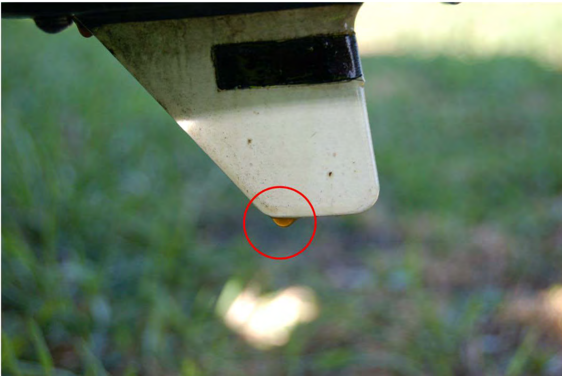
Figur 3: Lys og klar olje fra lekkasjen på antenne under buken (se figur 2). Foto: SHT
