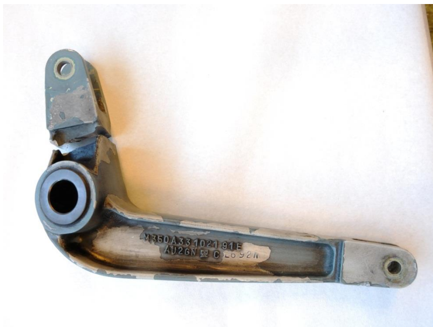
Figur 4: Kontrollarm for halerotor. Foto: SHT
