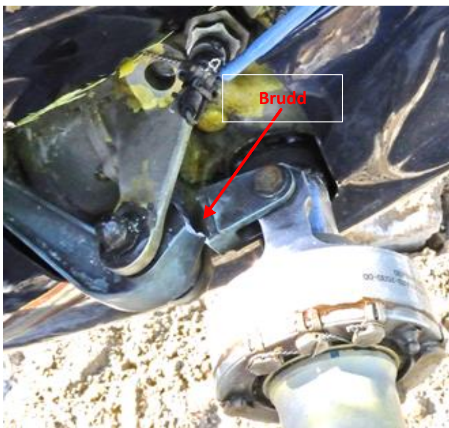
Figur 3: Bruddet i kontrollarmen slik det ble funnet Foto: SHT
