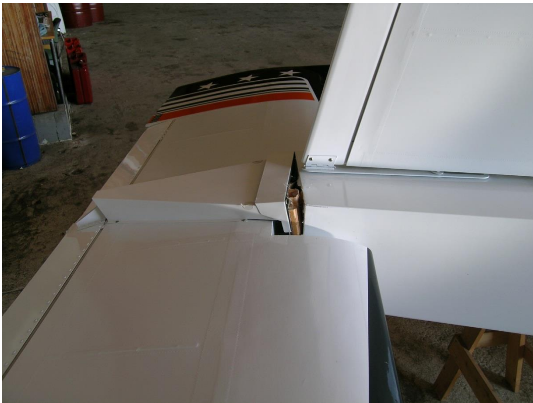
Figur 2: Den horisontale haleflaten slik den ble slått skjev i innfestingen. Foto: SHT
