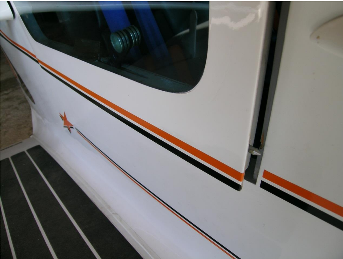
Figur 3: Håndtaket framme i låst stilling med den fremre låsepinnen på utsiden av hullet i dørkarmen (høyre dør). Foto: SHT
