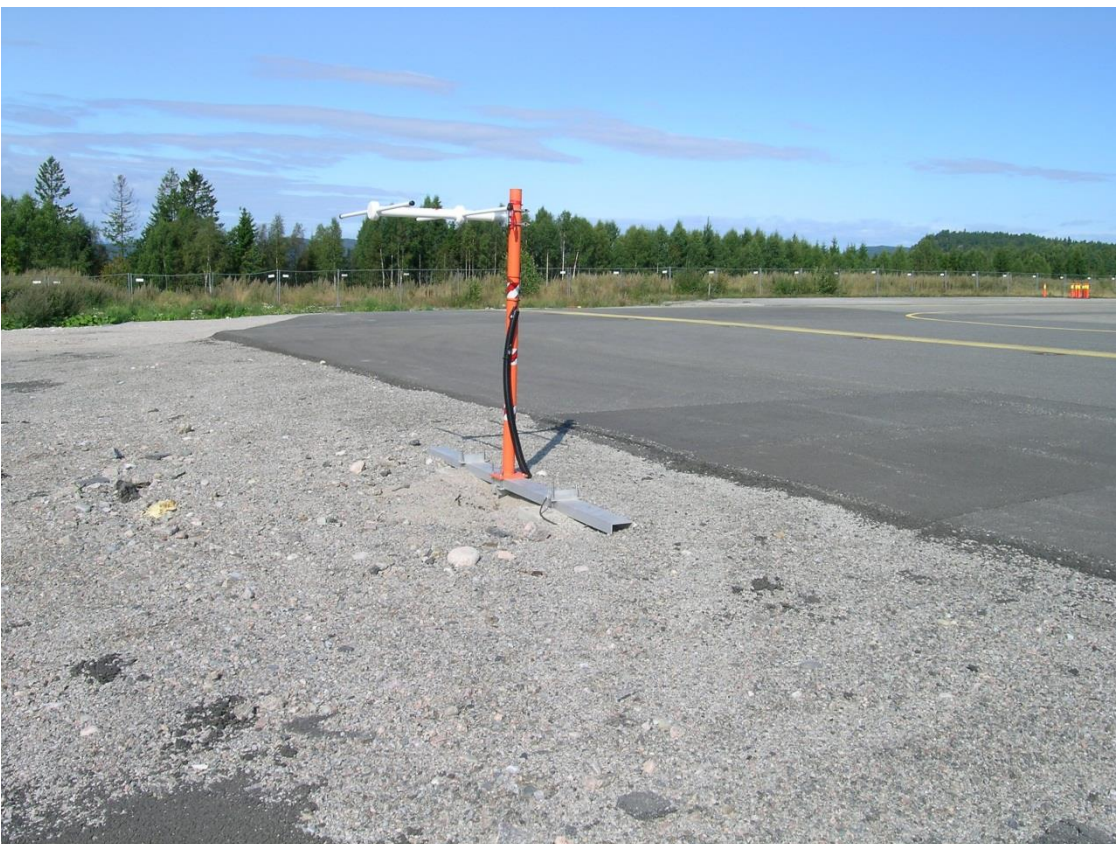
Figur 4: Monitor-antennen foran terskelen til rullebane 01 etter at den ble reparert. Tre av de fire horisontale fingrene på antennen ble slått av i sammenstøtet med flyet. Foto: SHT
