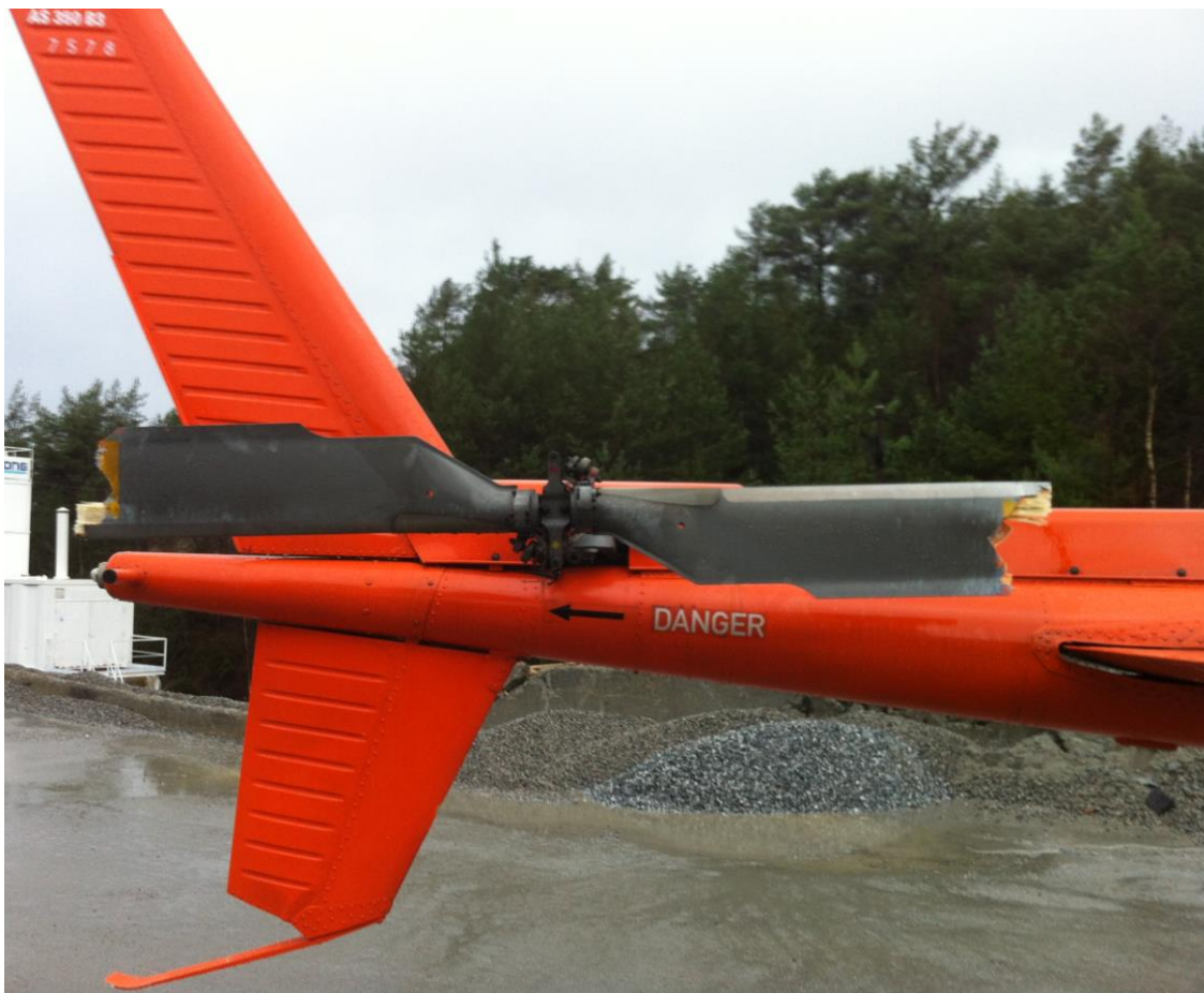
Figur 2: Skader på halerotor, halerotorbeskytter og nedre vertikale finne. Foto: Nord Helikopter
