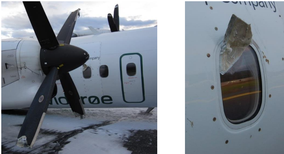
Figur 12: Propellbit som har skjært seg fast ved et vindu. Foto: SHT
