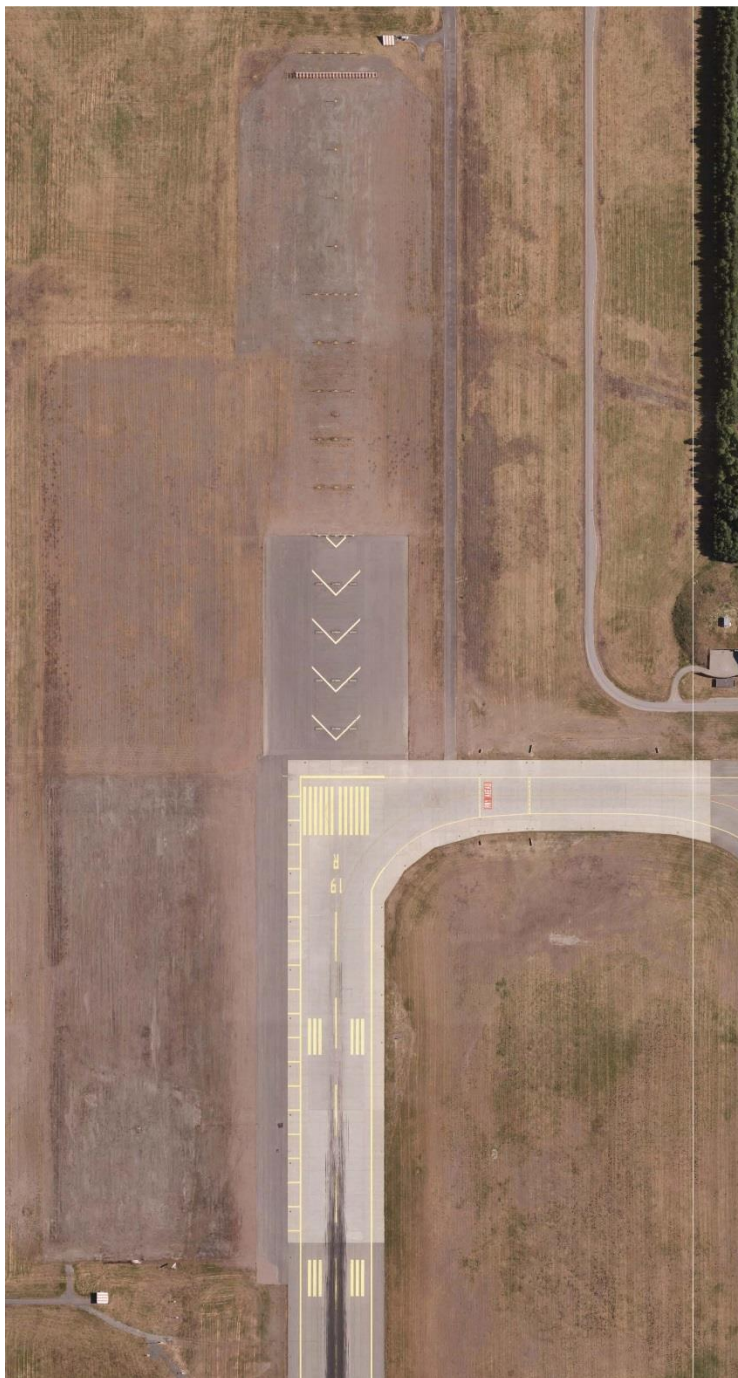
Figur 2: Rullebaneende 01L, vestre rullebane i nord, samt RESA (Runway End Safety Area). Det er tydelig å se hvor betongen begynner. Det svarte feltet er avsetning av gummi fra landinger nordfra (19R). Kilde: Ortofoto fra Oslo lufthavn AS
