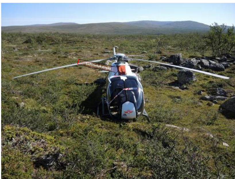
Figur 6: Påmontert trekk på luftinntak. Foto: SHT
