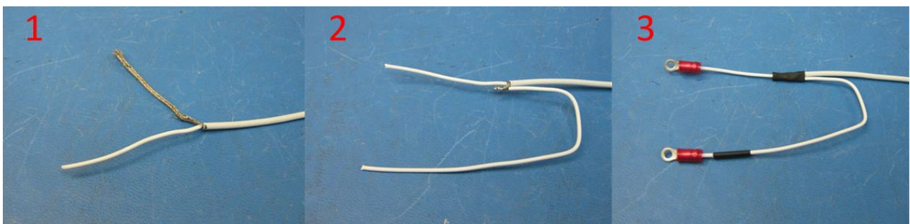
Figur 5: Riktig terminering av skjermet ledning mellom magnet og tenningsbryter. Kilde: verticalpower.com
