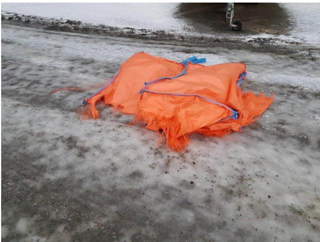
Figur 3: Lastesekken (bigbag) etter at den hadde vært i kontakt med rotoren. Den landet ca. 25 m fra helikopteret. Foto: Helitrans AS
