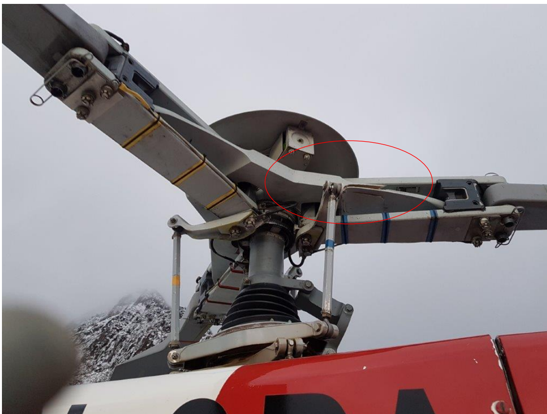
Figur 4: En brukket arm på hovedrotorens Starflex er markert med rød ring. Foto: Helitrans AS
