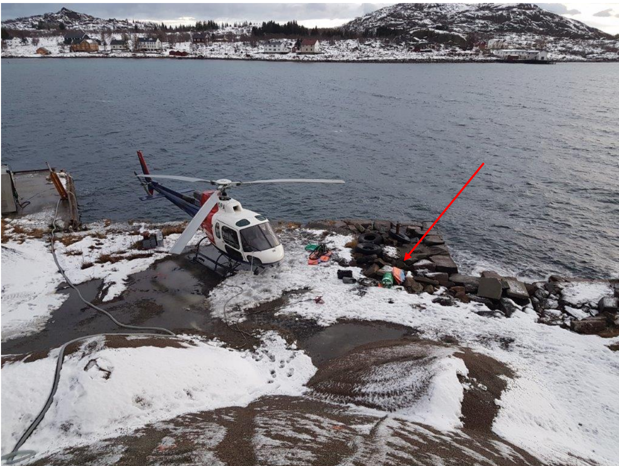
Figur 1: Landingsplassen på kaia. Bildet er tatt innenfor en time etter havariet. Helikopteret står med fronten mot vest. Rød pil viser hvor lastesekken (bigbag) som var fylt med utstyr var plassert. Den fløy opp da helikopteret landet og ble ført inn i hovedrotoren. Den andre samlingen med utstyr og flatpakkede lastesekker, til venstre, nærmere helikopteret, lå i ro. Foto: Helitrans AS
