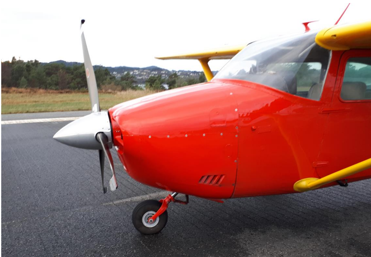
Figur 1: Skade på nesehjulsleggens innfesting og propell. Foto: Privat
