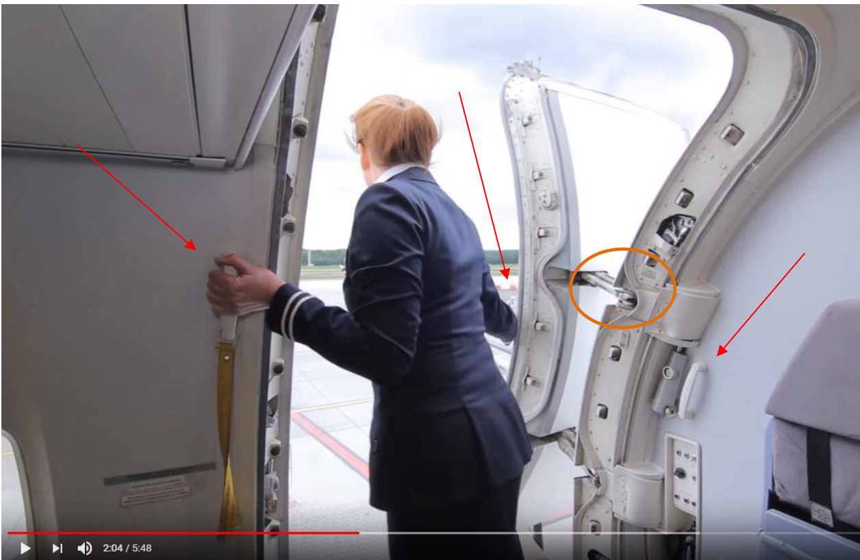
Figur 4: Klipp fra filmen som flyselskapet benytter i opplæring for kabinbesetningen. Filmen demonstrerer bruk av de ulike dør- og veggmonterte håndtakene til bruk under åpning og lukking av kabindøra i Boeing 737. (Plasseringen av håndtakene og «Lock release latch» er markert med henholdsvis røde piler og orange ring av SHT.) Illustrasjon: Norwegians opplæringsprogram
