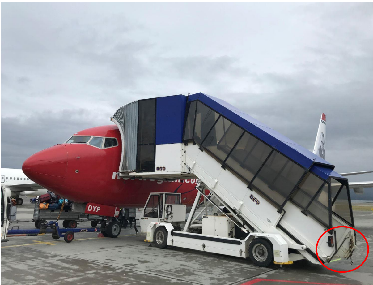
Figur 1: Det aktuelle passasjertrapp-kjøretøyet på Alta lufthavn, tilknyttet et tilsvarende fly fra Norwegian (LN-DYP) ved en senere anledning. Passasjertrappen er overbygd og utstyrt med belg. Belgene gir redusert mulighet for innsyn og utsyn fra sidene. Man kan vanskelig se hvorvidt kabindøra er åpen eller lukket annet enn ved direkte innsyn opp i passasjertrappen (høyre i bildet). Sikkerhetsbåndet, som her henger umontert, er markert med rød ring. Foto: SHT
