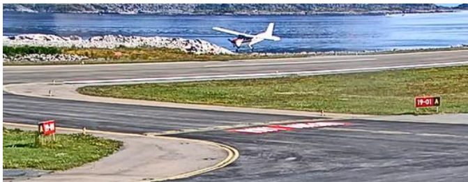
Figur 1: Flyet har hatt flere tidligere sprett og er her på det høyeste. Kilde: Avinor
