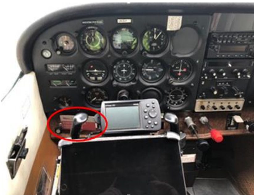
Figur 6: Korrekt plassering av stikkelås (markert med rød sirkel). Foto: Fartøysjef. Illustrasjon: Havarikommisjonen
