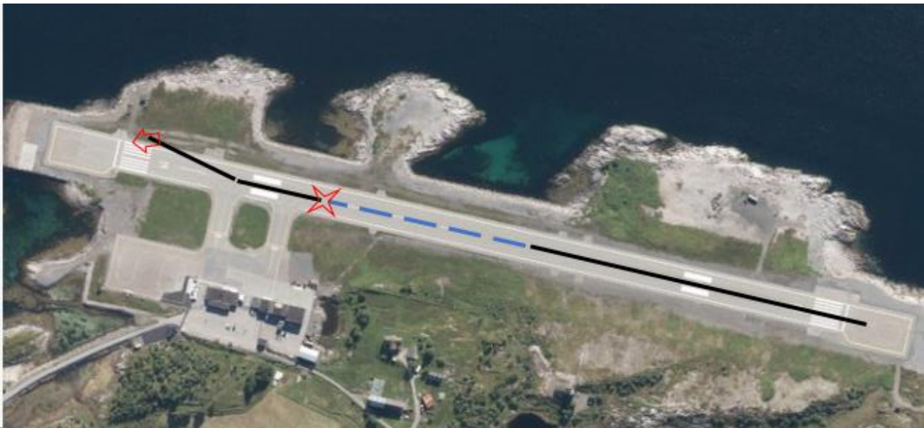
Figur 4: Sort linje illustrerer flyets ferd langsetter rullebanen. Blå stiplet linje illustrerer flere sprett opp i luften og ned igjen på rullebanen. Rød stjerne markerer hardt nedslag hvor flyet ble skadet. Rød pil markerer hvor flyet kom til ro. Kunngjort tilgjengelig avgangsdistanse på Helle er 1 016 meter. Foto: © Kartverket. Illustrasjon: Havarikommisjonen
