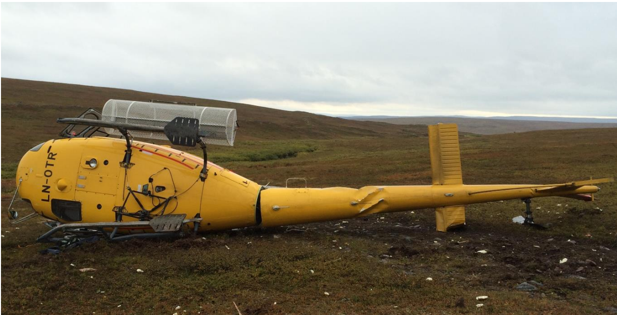
Figur 3: Skader sett fra helikopterets underside. Foto: Fartøysjef
