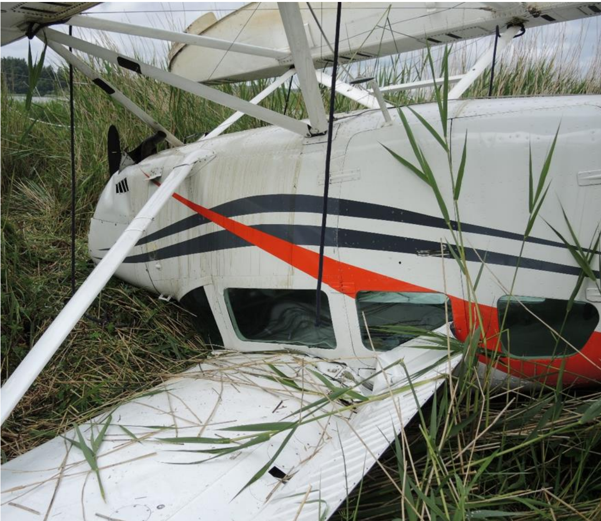
Figur 2: LN-BEM etter nødlandingen. Frøylandsvatnet i bakgrunnen. Oljesøl fra buken har rent ned langs fremre del av kroppen mellom motordekslet (cowling) og bakre flottørstag. Foto: Statens havarikommisjon
