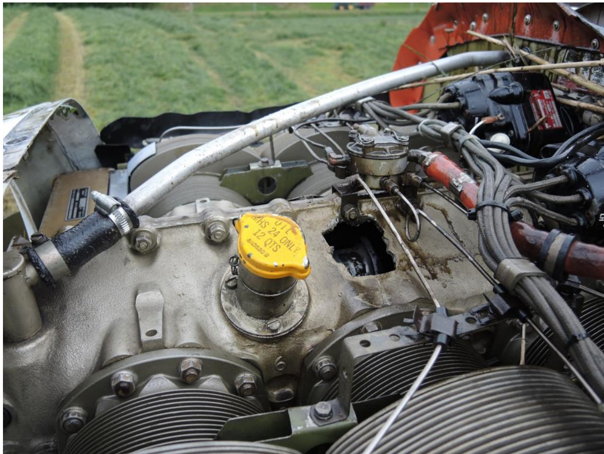
Figur 7: Hull i motorens veivhus. Foto: Statens havarikommisjon
