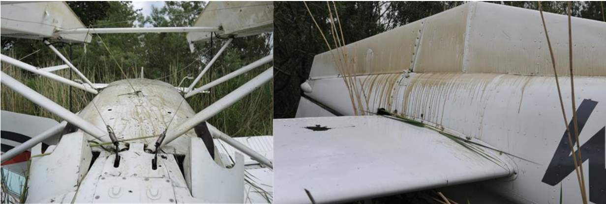
Figur 5: Oljesøl langs buken i hele flyskrogets lengde. Foto: Statens havarikommisjon / Politiet
