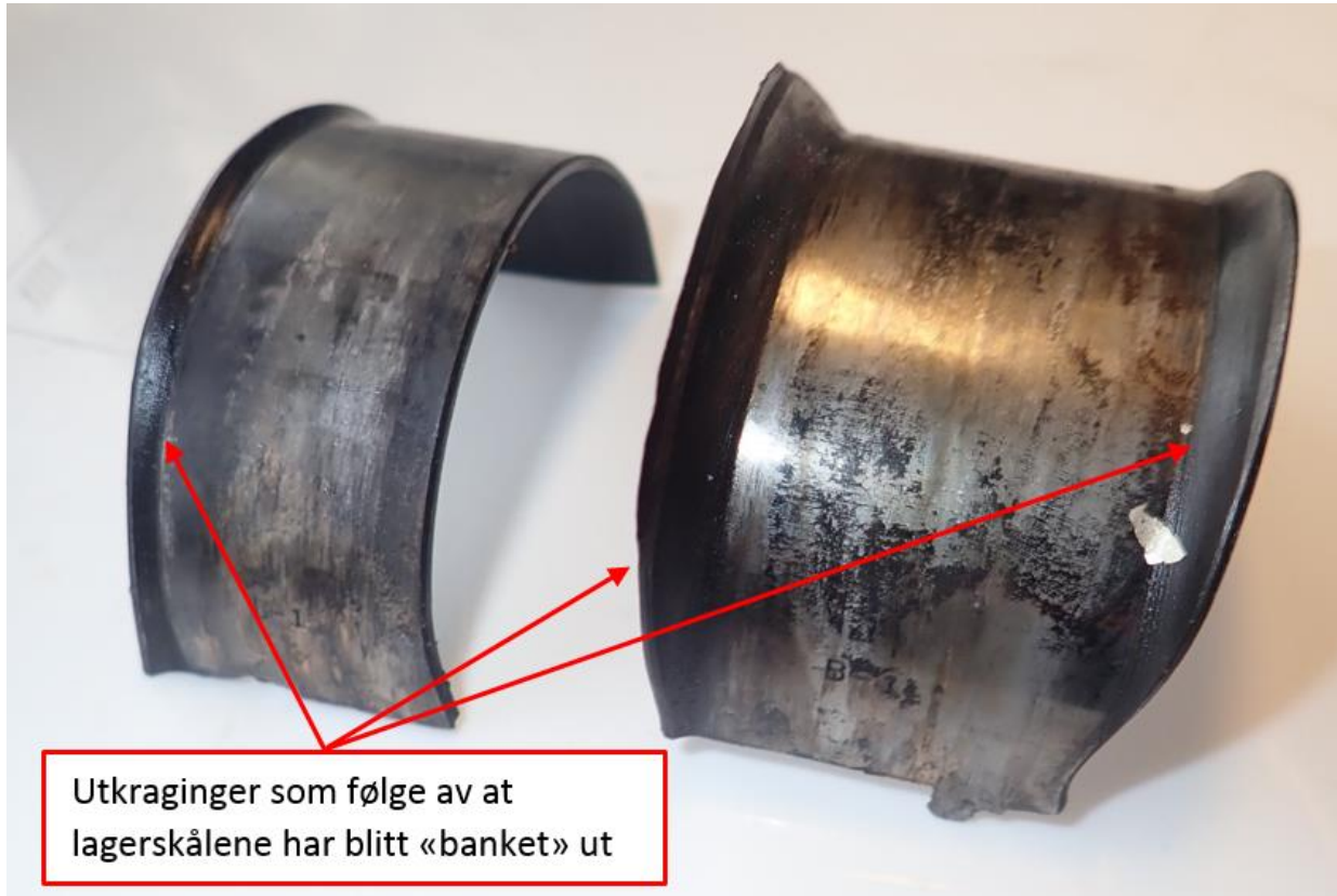
Figur 11: Deformerte lagerskåler. Foto: Statens havarikommisjon
