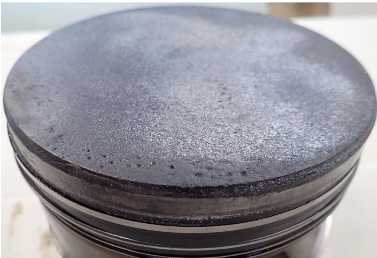
Figur 12: Stempel nr. 5 med indikasjoner på detonasjon. Foto: Statens havarikommisjon
