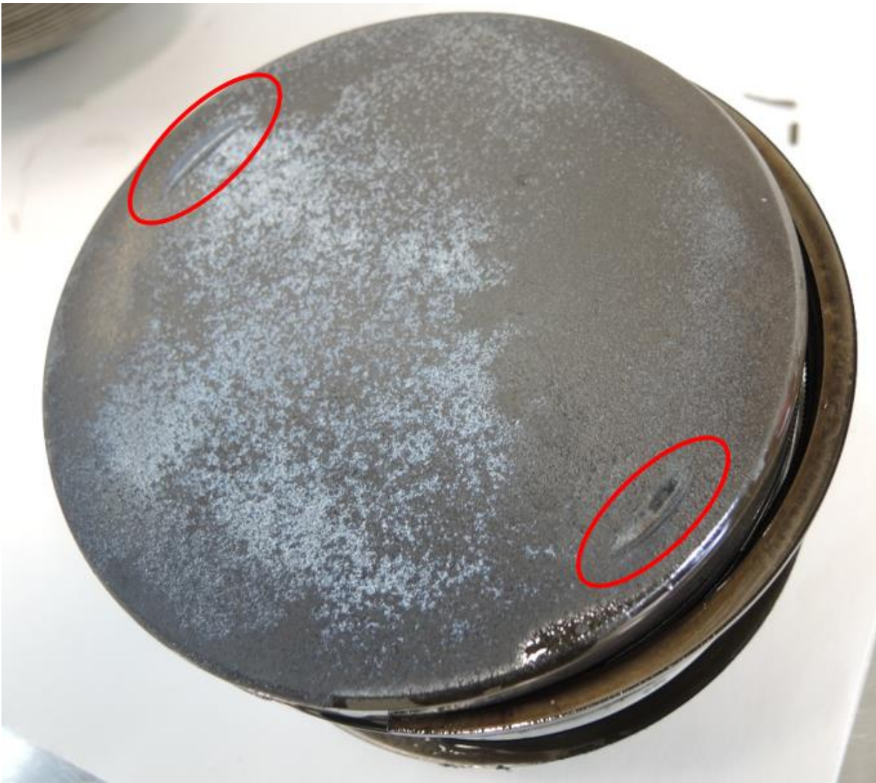
Figur 8: Merker (ringet inn med rød markering) etter ventiler i stempelkrone. Sylinder nr. 4. Foto: Statens havarikommisjon
