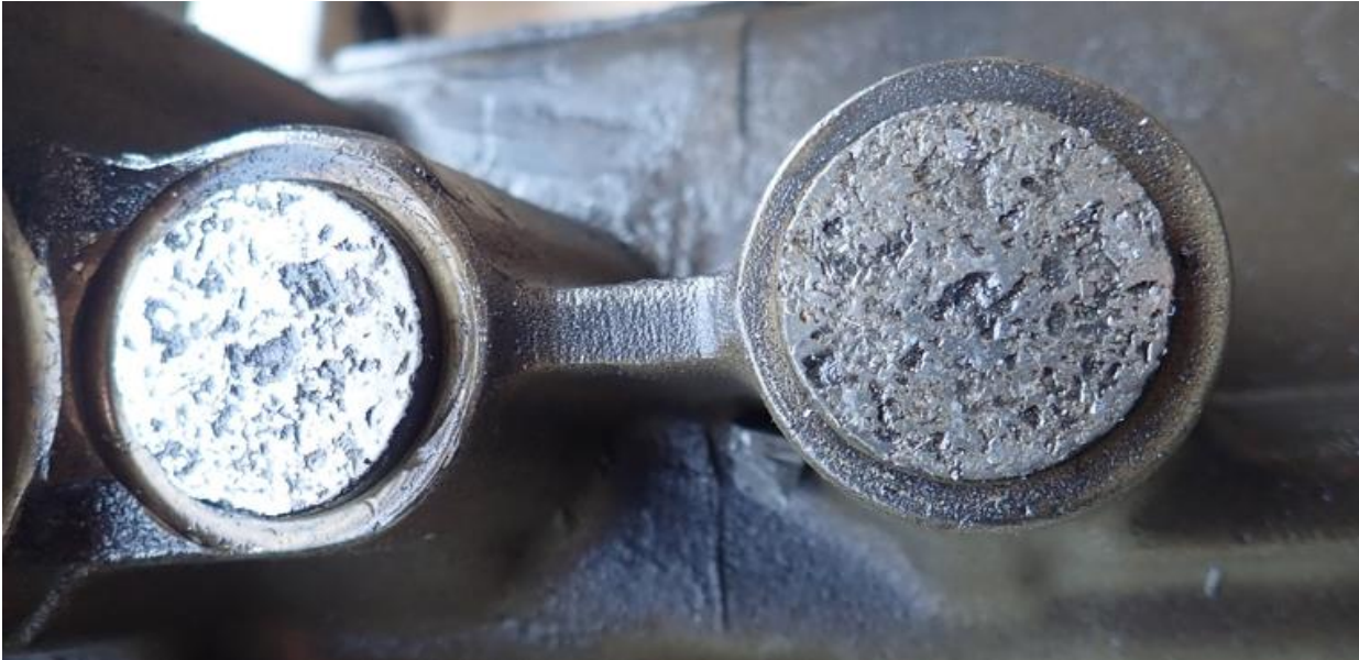
Figur 15: Korroderte ventilløftere. Foto: Statens havarikommisjon
