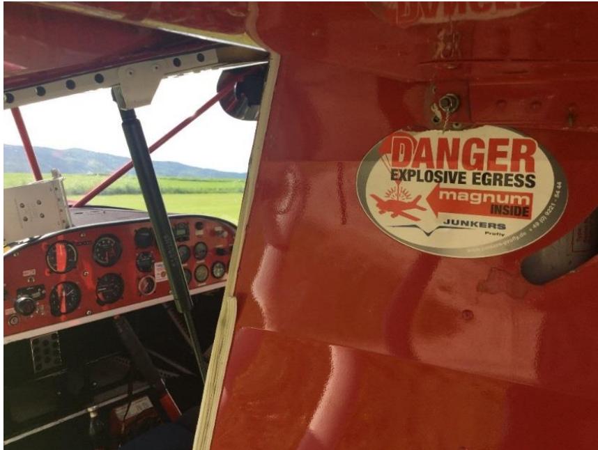
Figur 4: Advarsel på LN-YZU i form av et varselmerke som informerte om at det var installert et ballistisk redningsfallskjermssystem i luftfartøyet. Varselmerket fra 2011 var plassert ved venstre dør, i området under rakettskytningsåpningen. Det var også et varselmerke i dørkarmen med en pil oppover som angir hvor raketten befant seg. Varselmerket var ikke av den typen som leverandøren anbefalte. Foto: Privat, tidligere eier
