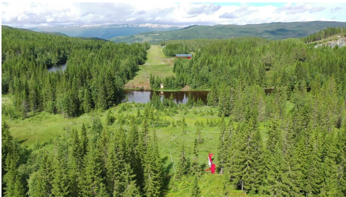
Figur 2: Øian flyplass Meråker, med utsikt nordover, langs rullebane 34. Hangaren ses på høyre side av rullebanen. LN-YZU ses liggende med venstre side ned mot bakken i myrlendt skogsterreng 258 m fra enden på rullebane 34. Bildet viser at flyplassen ligger i en dal og at det er svakt stigende terreng i vest, øst og sør for rullebanen. Dronefoto: SHK
