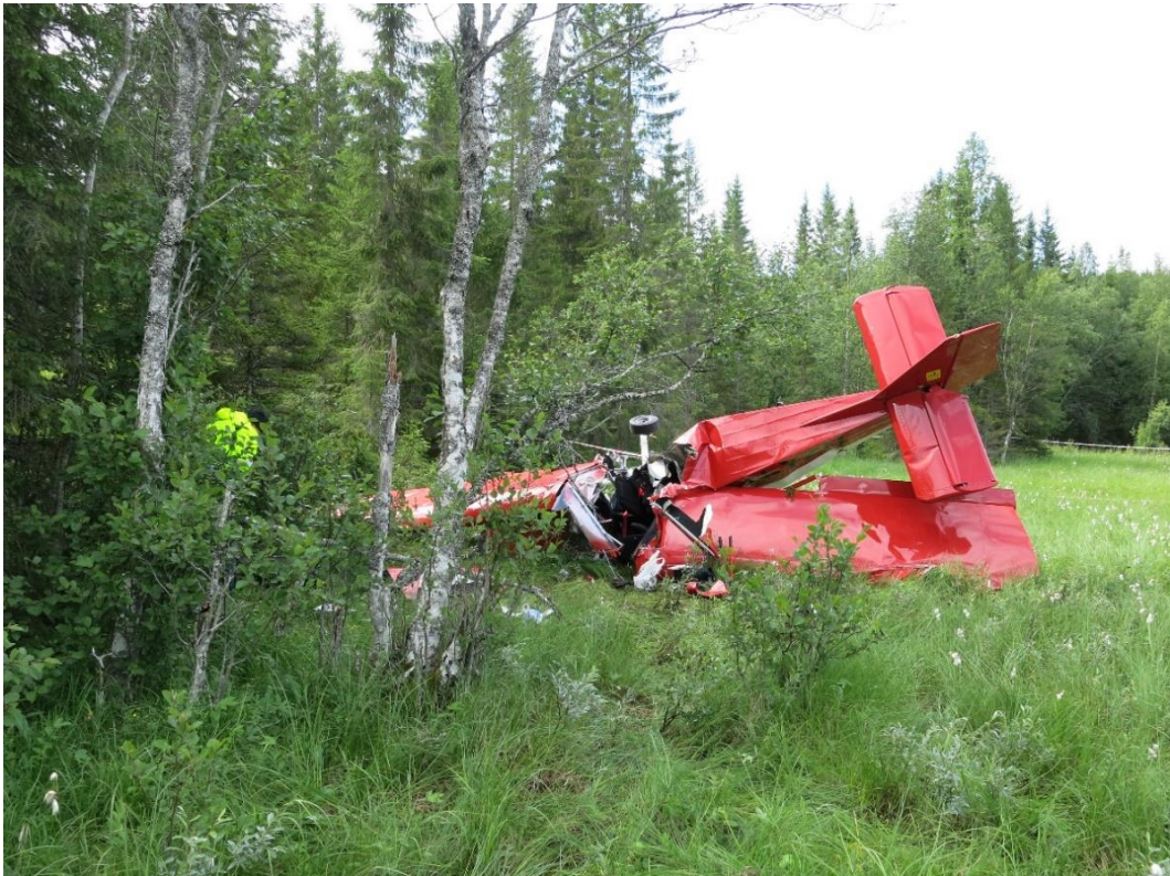
Figur 6: LN-YZU, slik flyet ble liggende i myrlendt terreng. Flyskroget ligger ca. 130 grader i forhold til fartsretningen. Bildet er tatt mot vest. Cockpitområdet ligger åpent vendt mot øst. Foto: SHK
