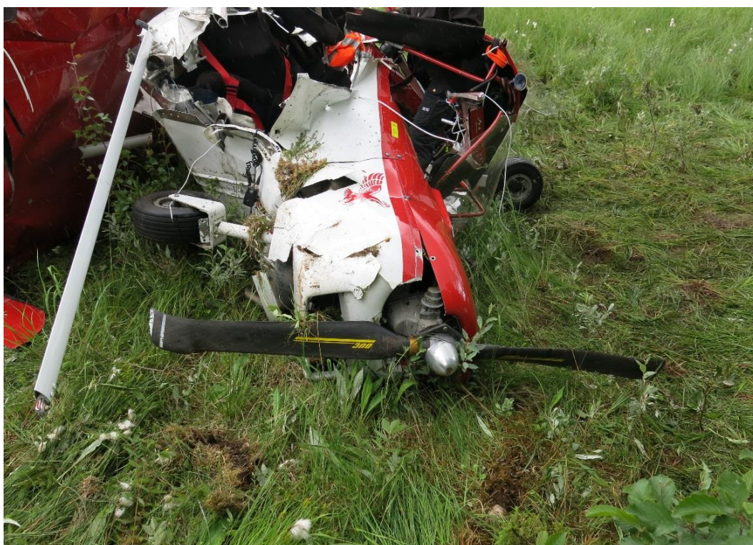
Figur 8: Bilde tatt av LN-YZU i retning nordover mot flyplassen, etter at den høyre vingen var løftet vekk fra motor- og propellområdet. Bildet viser spor etter propellslag i bakken. Bildet viser for øvrig store strukturelle skader på fremre høyre side av flyet, der aluminiumsplatene i skroget er spjæret. Foto: SHK
