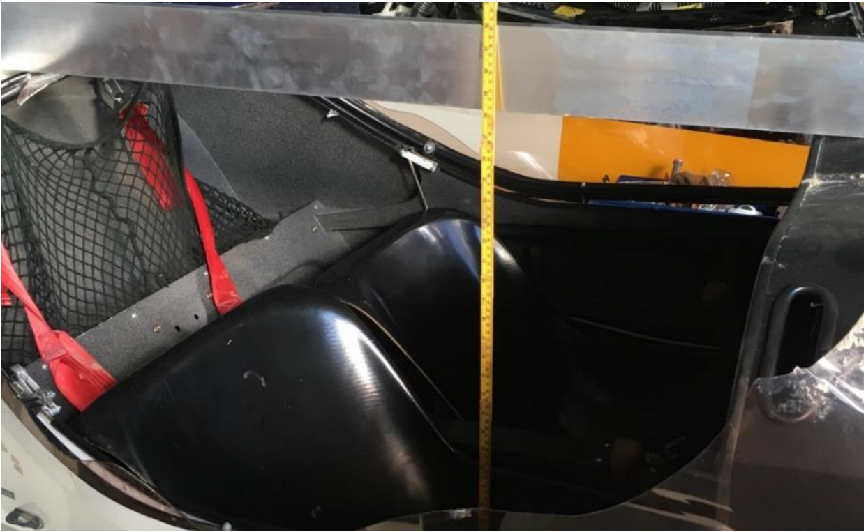
Figur 10: Avstand fra setet til bakken etter velt der canopy er knust. Bakken er illustrert ved en rettholdt. Foto: SHK
