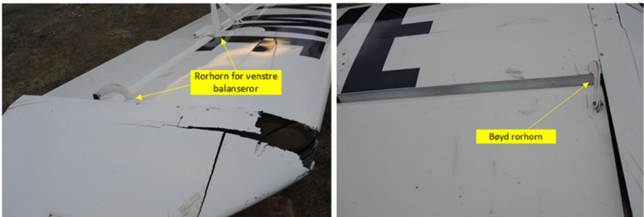
Figur 9: Bildet til venstre viser undersiden av venstre vinge som traff bilen. Bildet til høyre viser at ror-hornet er bøyd. Avstandene mellom sporene/ripene på den mørke bilens panser og frontrute stemmer overens med avstanden mellom ror-horn på venstre vinges balanseror. Foto og illustrasjon: SHK
