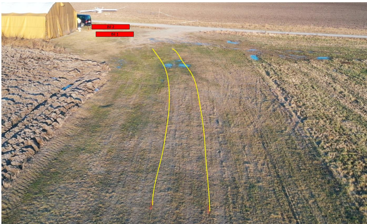
Figur 7: Flyvraket, bilenes plassering og spor i rullebanen etter flyets hovedhjul. Siste spor etter flyet ble målt til 17 m før bil nr.1. Dronevideo: Politiet. Skjermdump og illustrasjon: SHK
