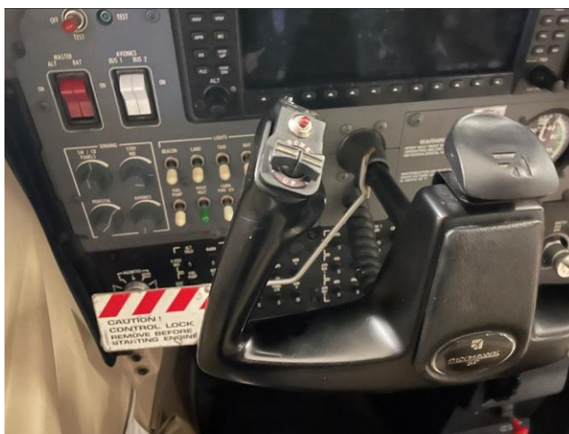
Figur 2: Eksempel på Cessna stikkelås med metallplate (C 172). Foto: Havarikommisjonen
