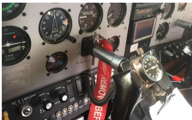
Figur 1: Stikkelåsen i LN-VYN. Foto: Fartøysjef
