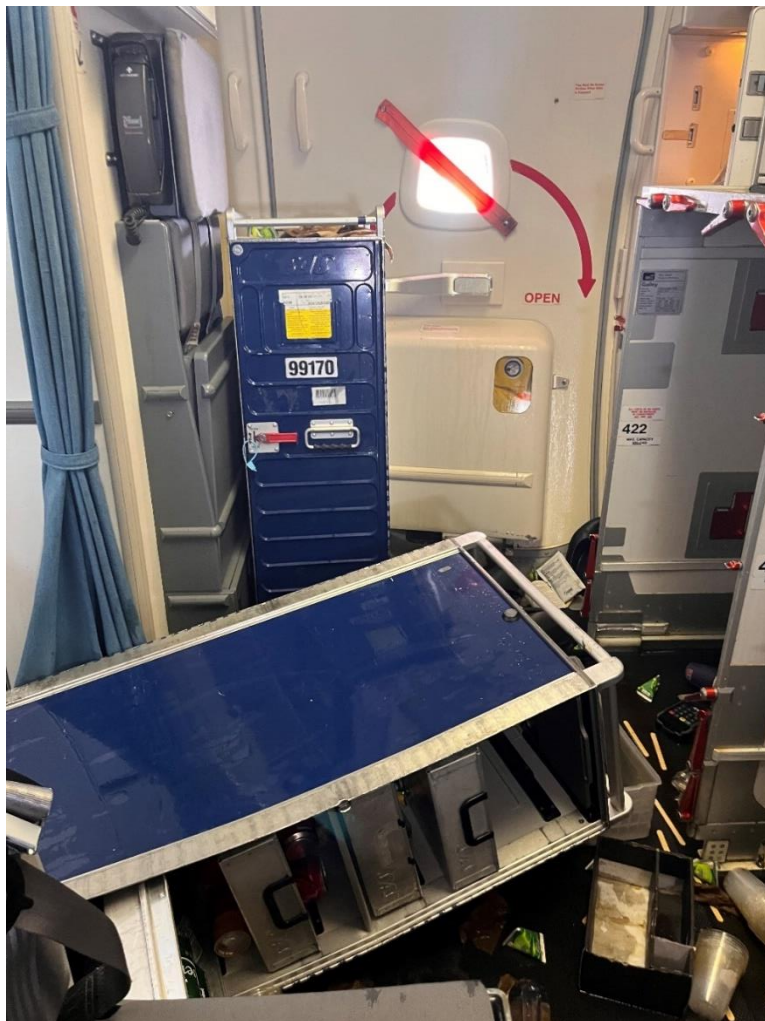
Figur 3: Mobilfoto tatt kl. 1610, rett etter at rystelsene hadde stilnet. Den ene serveringsvogna var reist opp og skjøvet unna. Den andre lå fremdeles på gulvet. Til høyre ses benken med oppbevaringsrom og hendler for å sikre serveringsvognene. Foto: Kabinansatt
