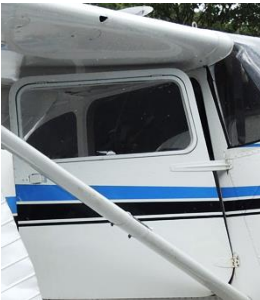
Figur 5: Høgre dør med topphengsla sidevindauge. Då flyet slutta å bevege seg etter å ha slått rundt på sjøen, evakuerte dei fire om bord gjennom sidevindaugget. Vindaugsopninga er 76 x 33 cm. Døra blei ikkje opna under evakueringa. Foto: Havarikommisjonen
