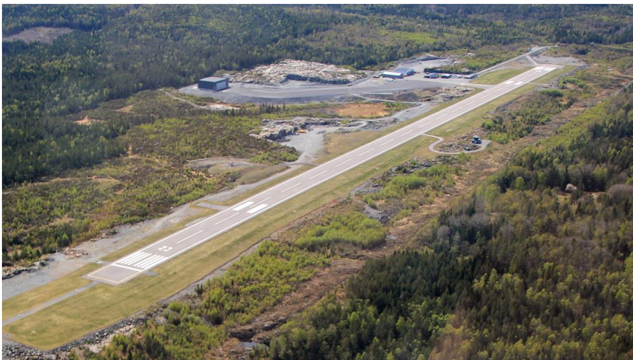
Figur 1: Arendal lufthavn, Gullknapp (ENGK). Rullebaneretning 05/23, rullebanedimensjon 1260 x 30 m. Foto er tatt mot sør. Nedlagt tårn på høyre side, driftsområde på venstre side. Foto: Arendal lufthavn Gullknapp
