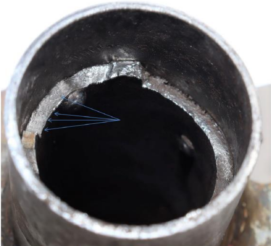
Figur 5 Bilde av bruddskade, blå piler angir potensielle sprekkstopplinjer.
