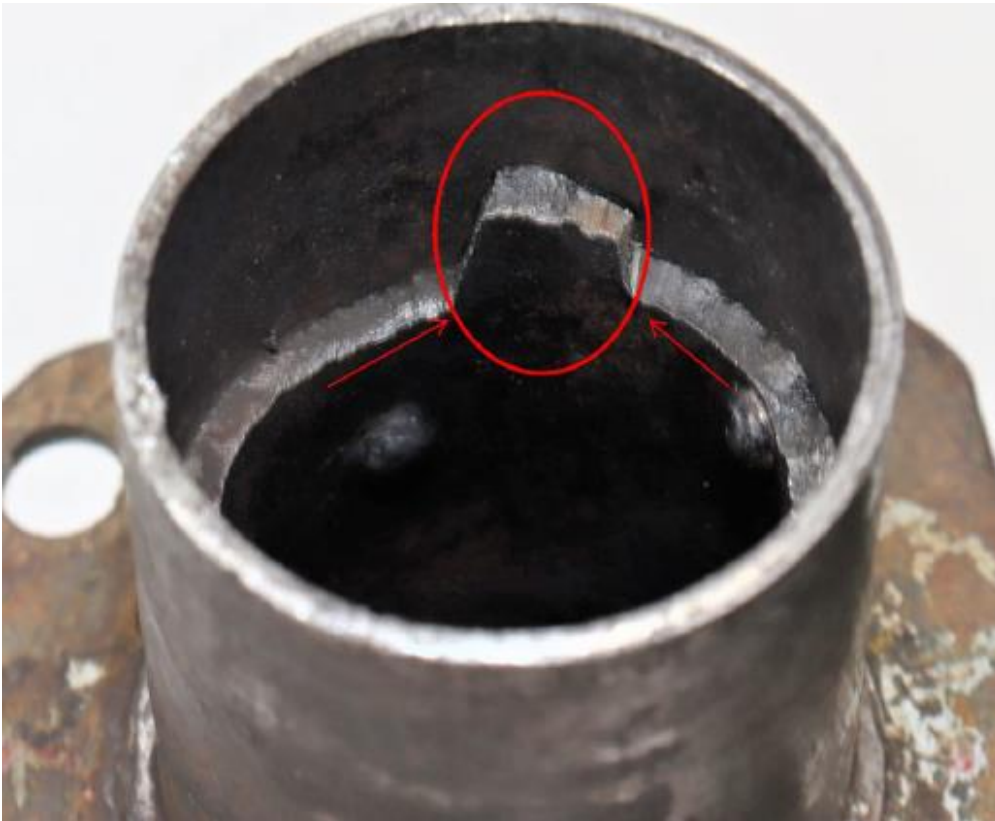
Figur 3: Bruddskaden. De røde pilene angir sannsynlig retning for sprekkeforplantningen fra sveisepunkter. Den røde sirkelen viser mulig restbrudd. Foto: FOLAT
