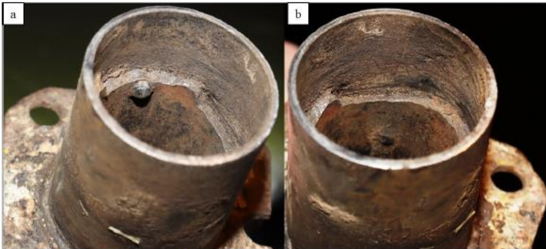
Figur 2ab: Bilder av bruddskade til aksling som mottatt.
