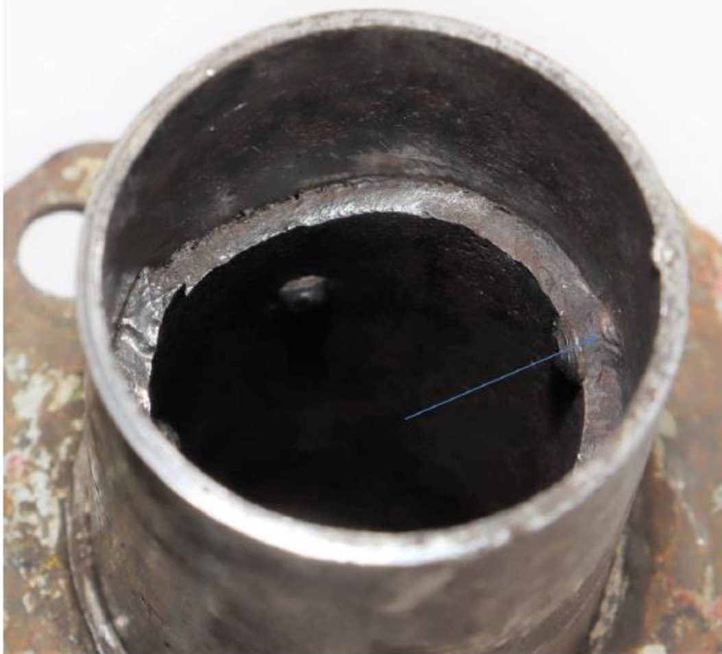
Figur 4 Bilde av bruddskade, blå pil angir område med mulig avvik i punktsveis.
