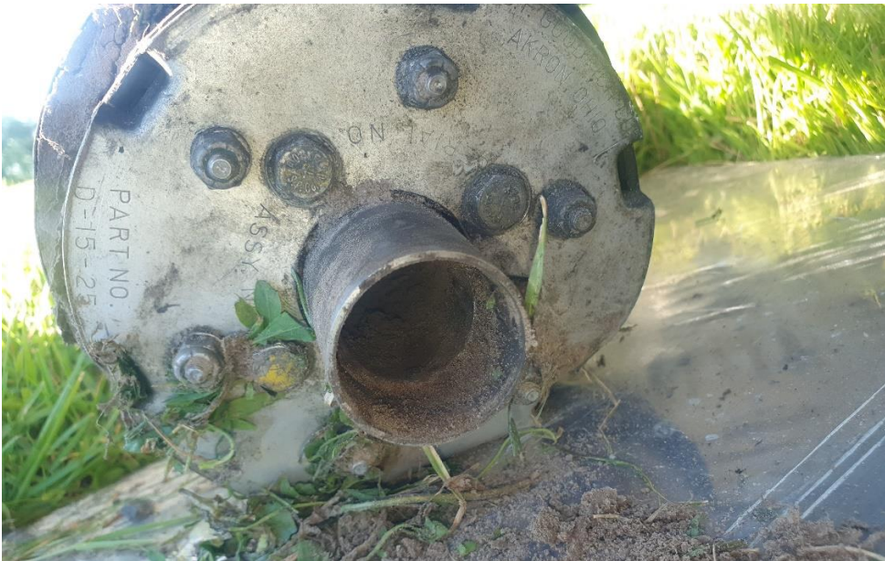
Figur 2: Venstre hjullegg kort tid etter landing. Bruddet kan sees ca. 1 cm innenfor foringen. Foto: Fartøysjef
