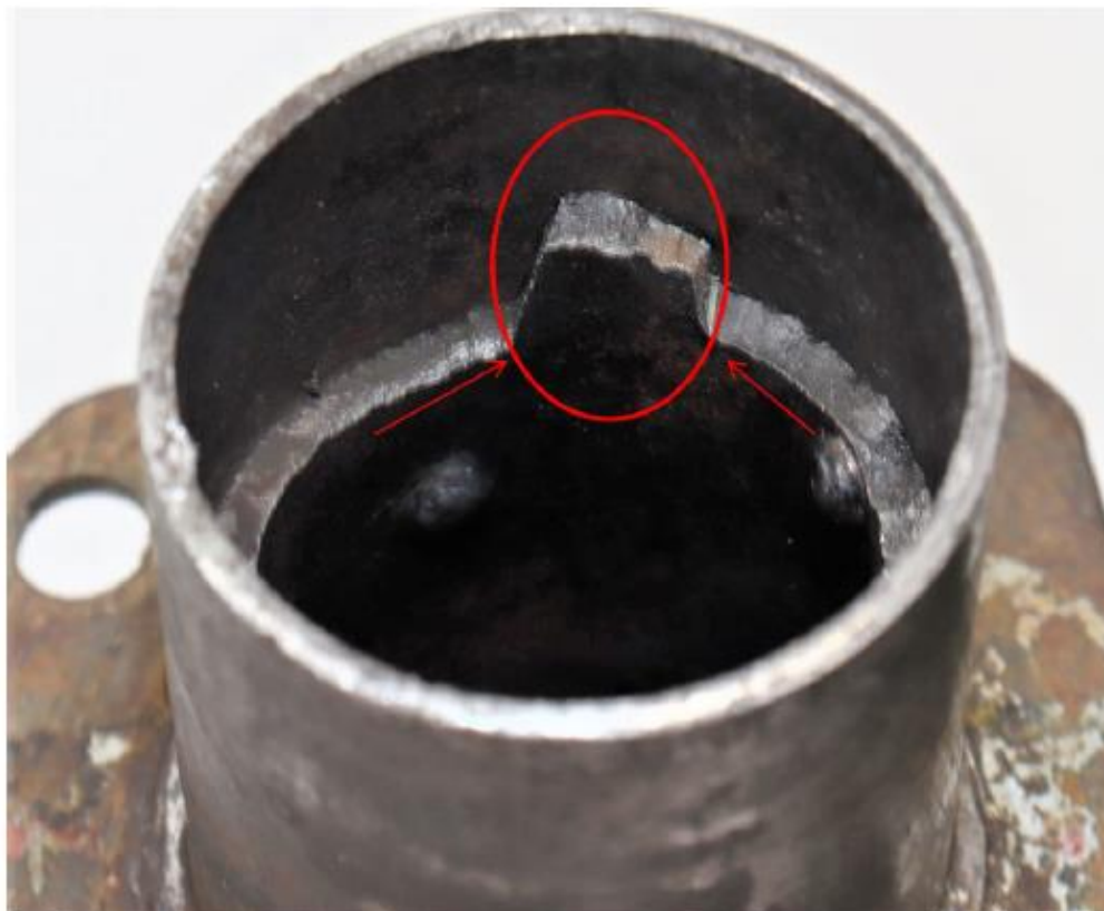
Figur 6 Bilde av bruddskade, røde piler angir sannsynlig retning på sprekkvekst. Rød sirkel angir område for mulig restbrudd.
