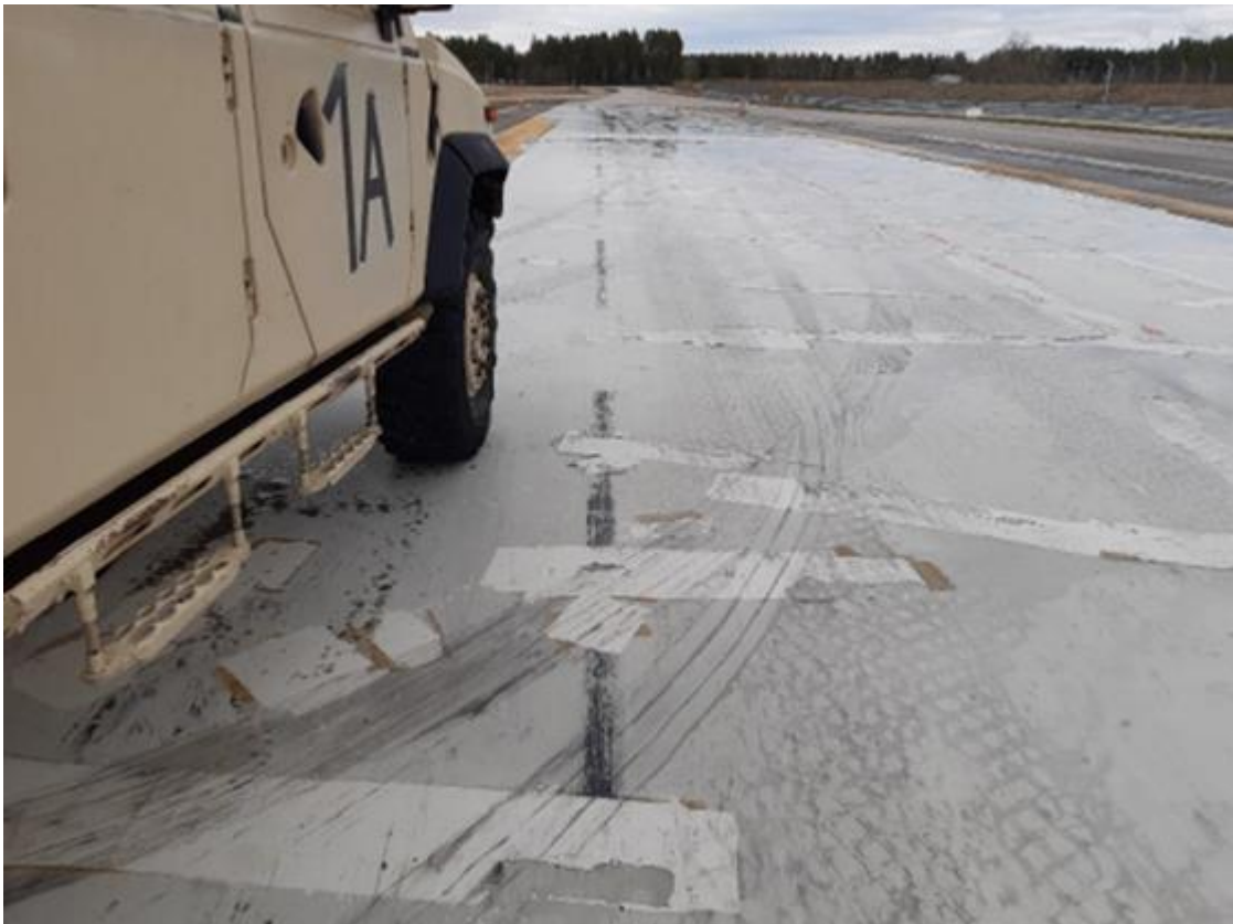
Figur 10: Hjulsporene viser at kjøretøyet snurret rundt sin egen akse 180° da skrensen inntraff, og stoppet ikke før det traff veiskulderen. Dekksporene viser at bakhjulene ikke roterte i siste del av testen. Foto: SHF
