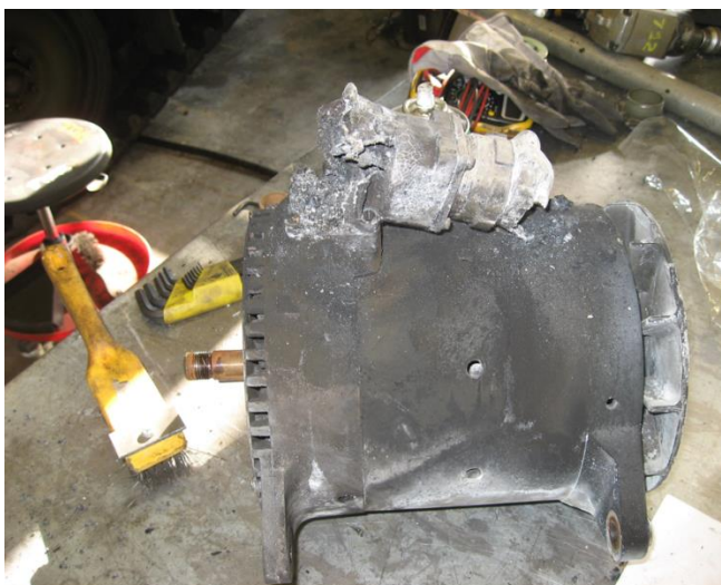
Figur 1: Brannskadet dynamo. Foto: Per Anders Bjørklund/Forsvaret
