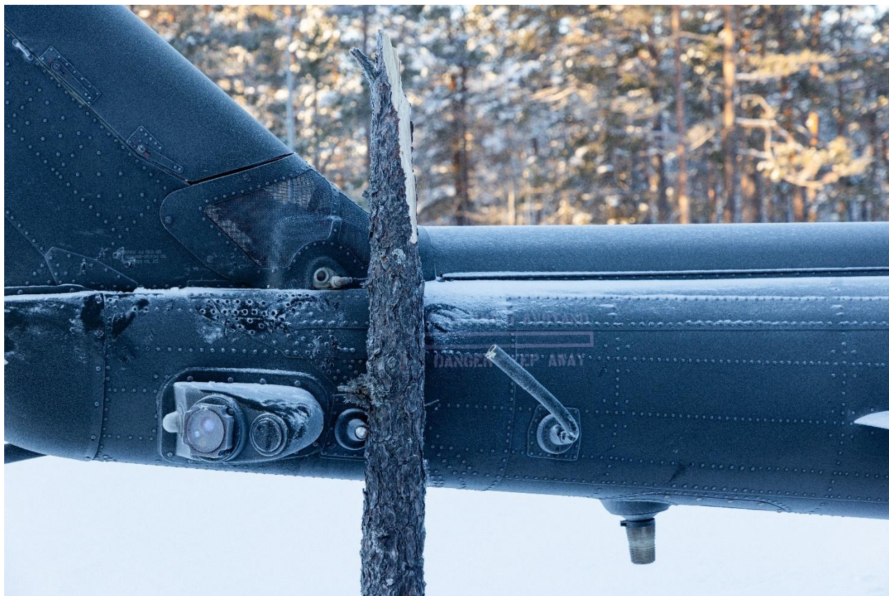
Figur 5: Skader på VOR-antenne. Foto: SHK
