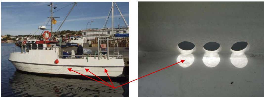
Figur 10: Dreneringsåpningene på en Nor-Dan 32 Sjark.
