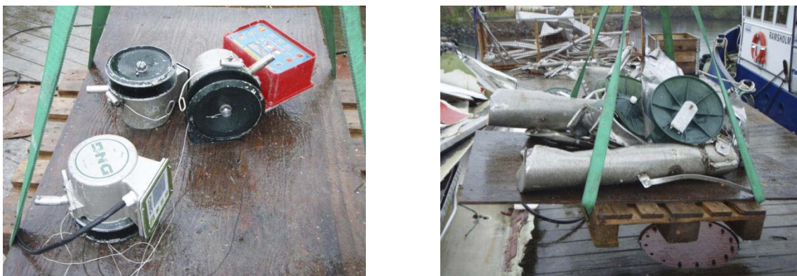
Figur 9: Veiling av dorgestyrret på Monica IV. Bildet til venstre viser dorgemaskinene og bildet til høyre viser deler av utliggerne samt trinser.
