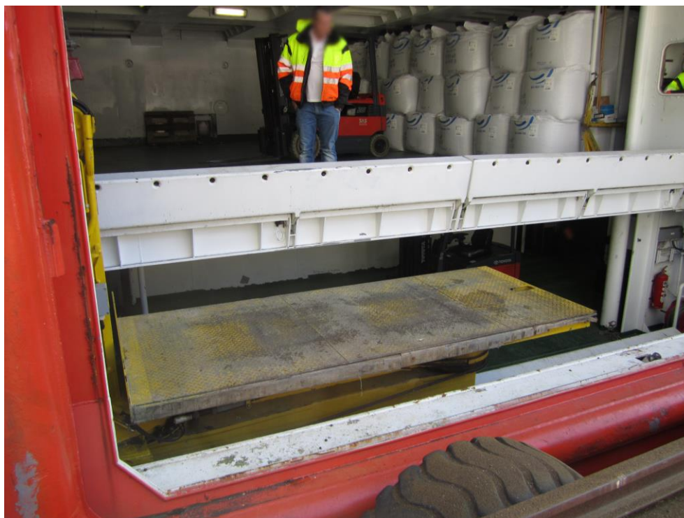
Figur 9: Palleheis på vei opp mot dekk 2, stållem oppslått. Foto: Politiet
