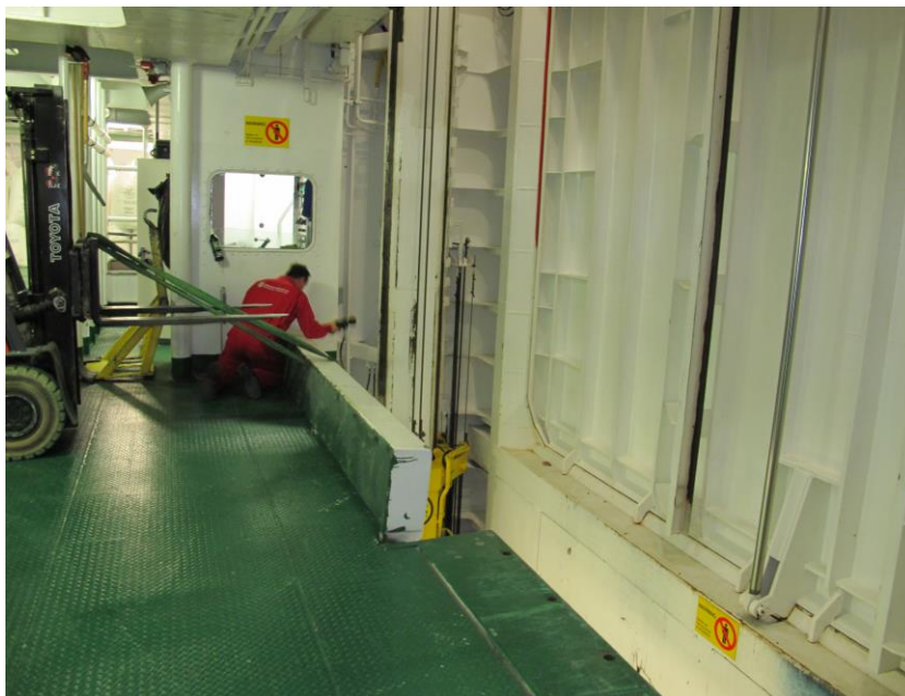
Figur 12: Stållemer utenfor kontrollrom med godt synlige forbudsskilt. Lemmer på øvre dekk vises på bildet til høyre. Den ene lemme hadde stropp på, pga. defekt hydraulikk. Foto: SHT
