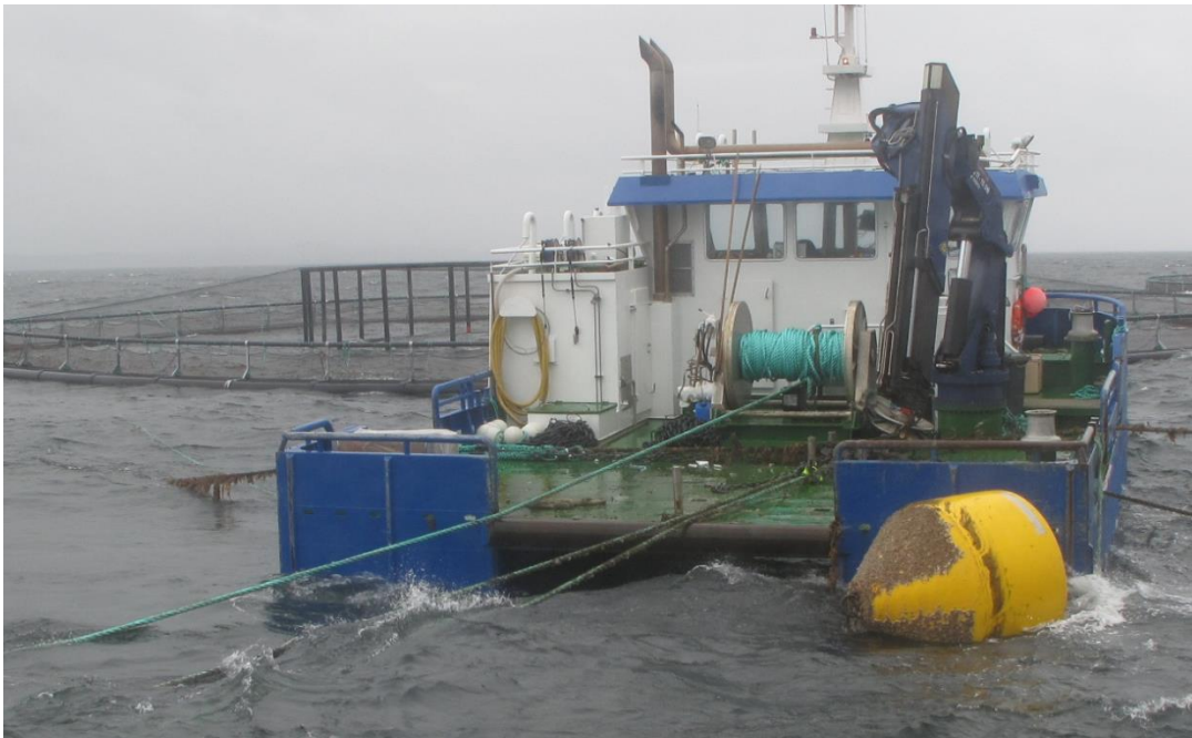
Figur 13: Akterdekk fotografert etter ulykken. Bildet viser at ankerline 6c har kommet over styrepinnen og ligger mot skanseledningen på babord side. Foto: Politiet
