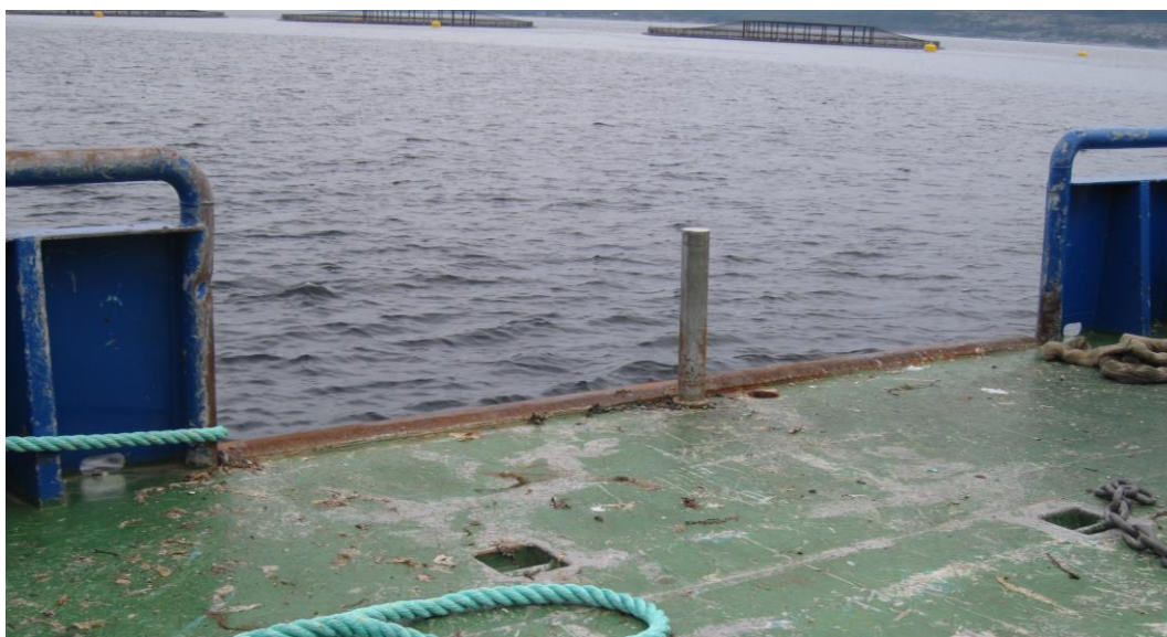
Figur 6: Bildet viser sliterøret over hekken, samt den styrepinnen som var montert på ulykkestidspunktet. Foto: SINTEF Fiskeri og havbruk AS
