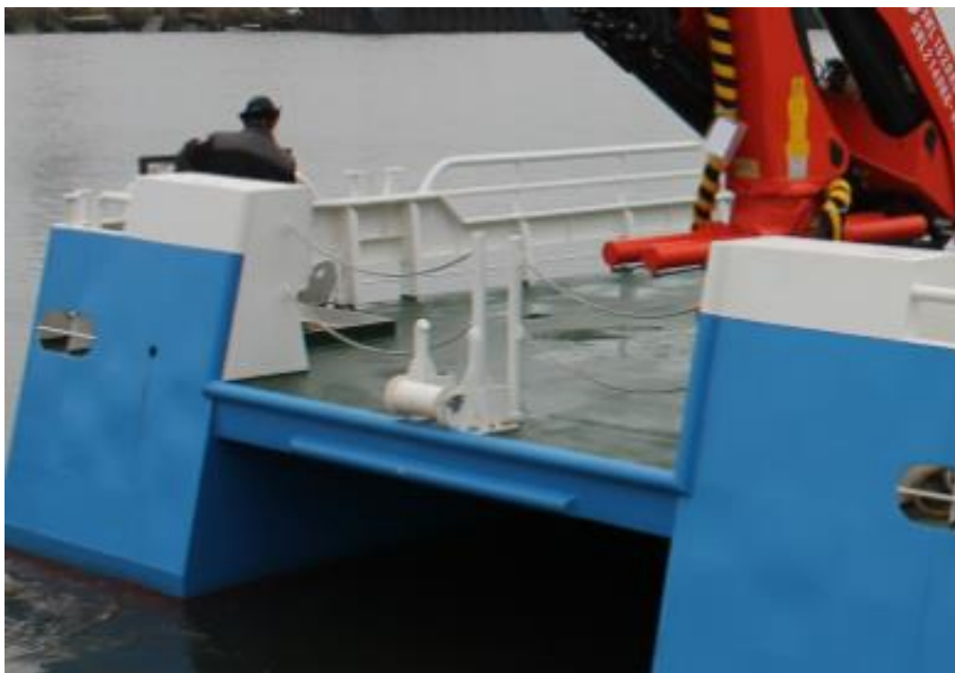
Figur 5: Et Ocea design med hekkrolle og styrepinner. Her er også kran og manøvrerhender plassert akterut på dekket. Foto: Ocea
