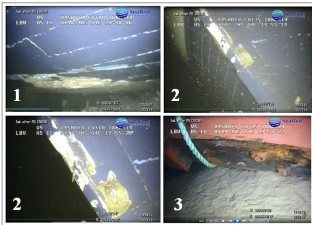
Figur 9: Øverst til venstre vises skaden på styrbord side. Øverst til høyre og nederst til venstre vises skaden i forstevnen. Nederst til høyre manglende bit av stråkjøl og tauet som løp ut fra lasteluka på dekk og over dekket på styrbord og rundt skroget. Foto/illustrasjon: SeaBed Services/SHT
