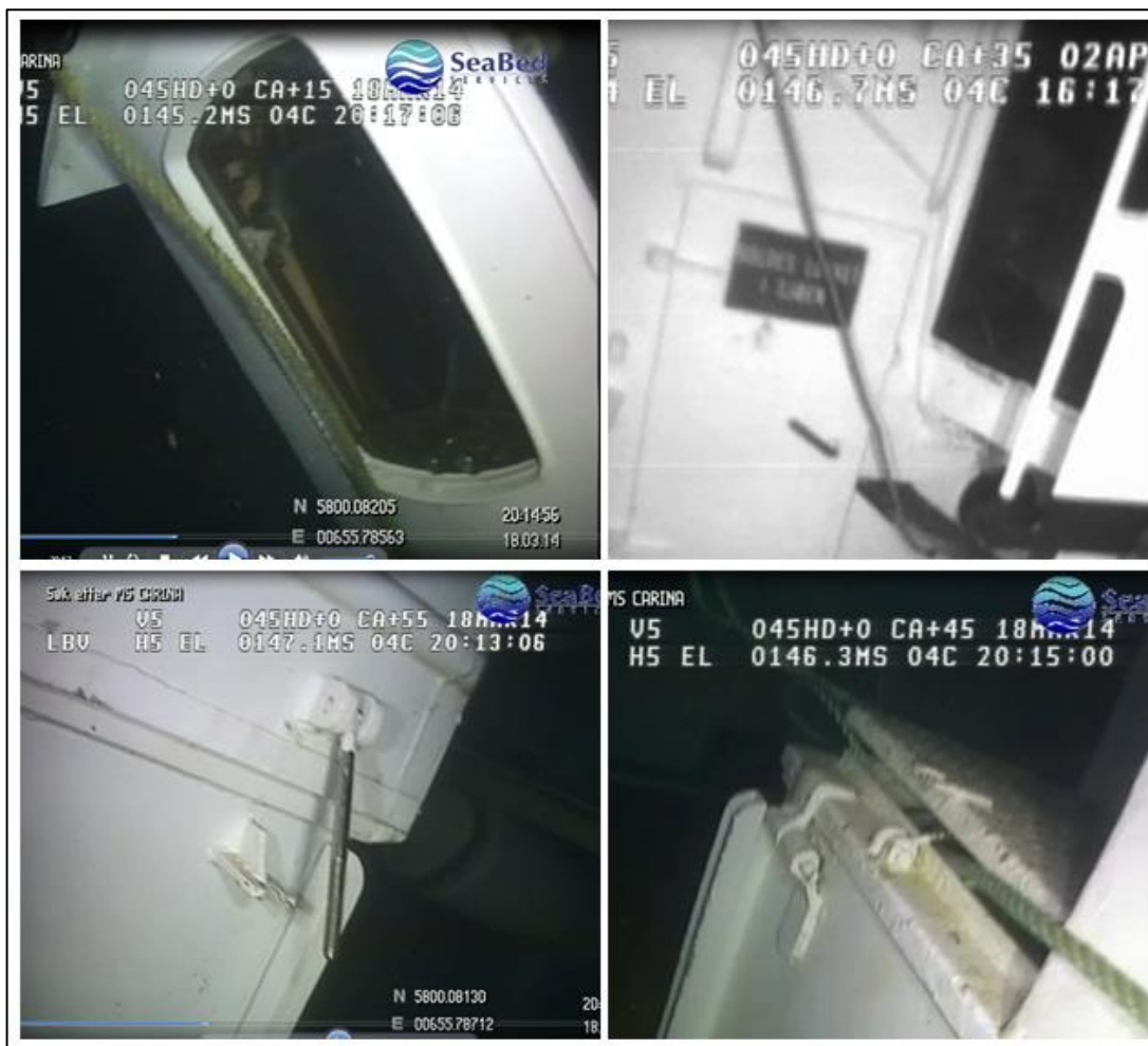
Figur 10: Øverst til venstre åpent styrhusvindu. Øverst til høyre stengt dør ned til maskinrom og åpen styrhusdør. Nederst til venstre ikke sikret ters. Nederst til høyre vises tauet som løper ut fra nedgangsluka, over dekk mot styrbord, under Carina og opp langs babord side. Foto: SeaBed Services/SHT
