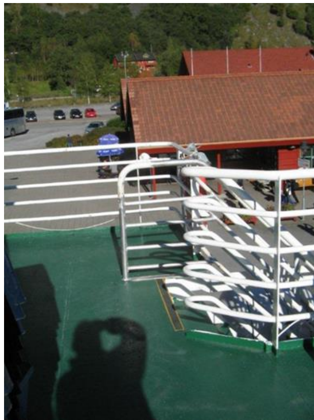
Figur 10: Forlenget rekkverk ved styrbord brotrapp. Foto: Rederiet
