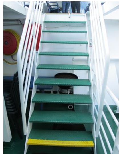
Figur 8: Styrbord brotrapp. Trappen var 3,0 meter lang og hadde 9 åpne trinn. Nederste trinn hadde gul kontrastfarge. Foto: SHT
