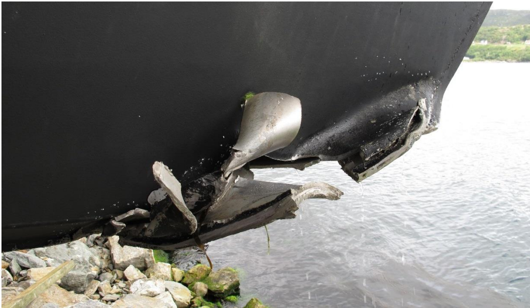
Figur 10: Skade i babord baug. Foto: SHT
