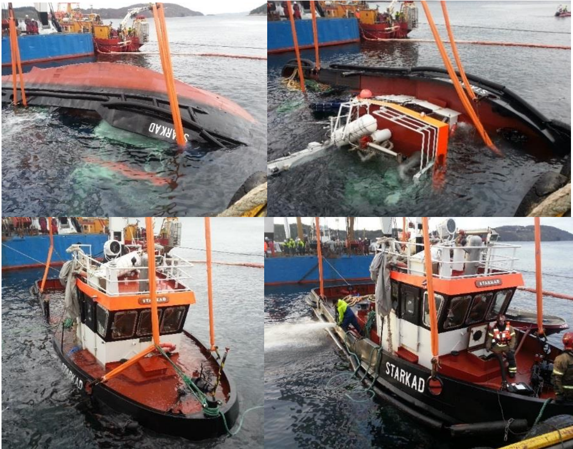
Figur 12: Starkad ble rettet og lenset 27. februar 2014. Foto: BK Marine AS
