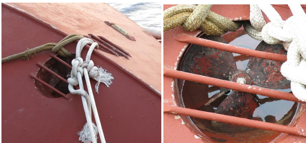
Figur 11: Sidepropell forut. Foto: SHT
