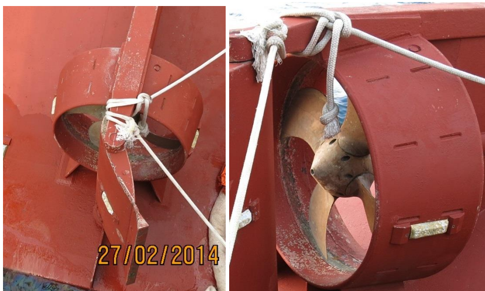
Figur 10: Rorutslag til babord og propellstigning 10 – 20 % forover. Foto: SHT
