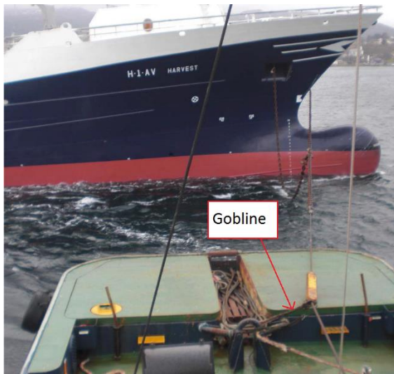
Figur 22: Gobline via slepeøye akter er sjaklet inn på slepeforbindelsen. Foto: FFS Atlas
