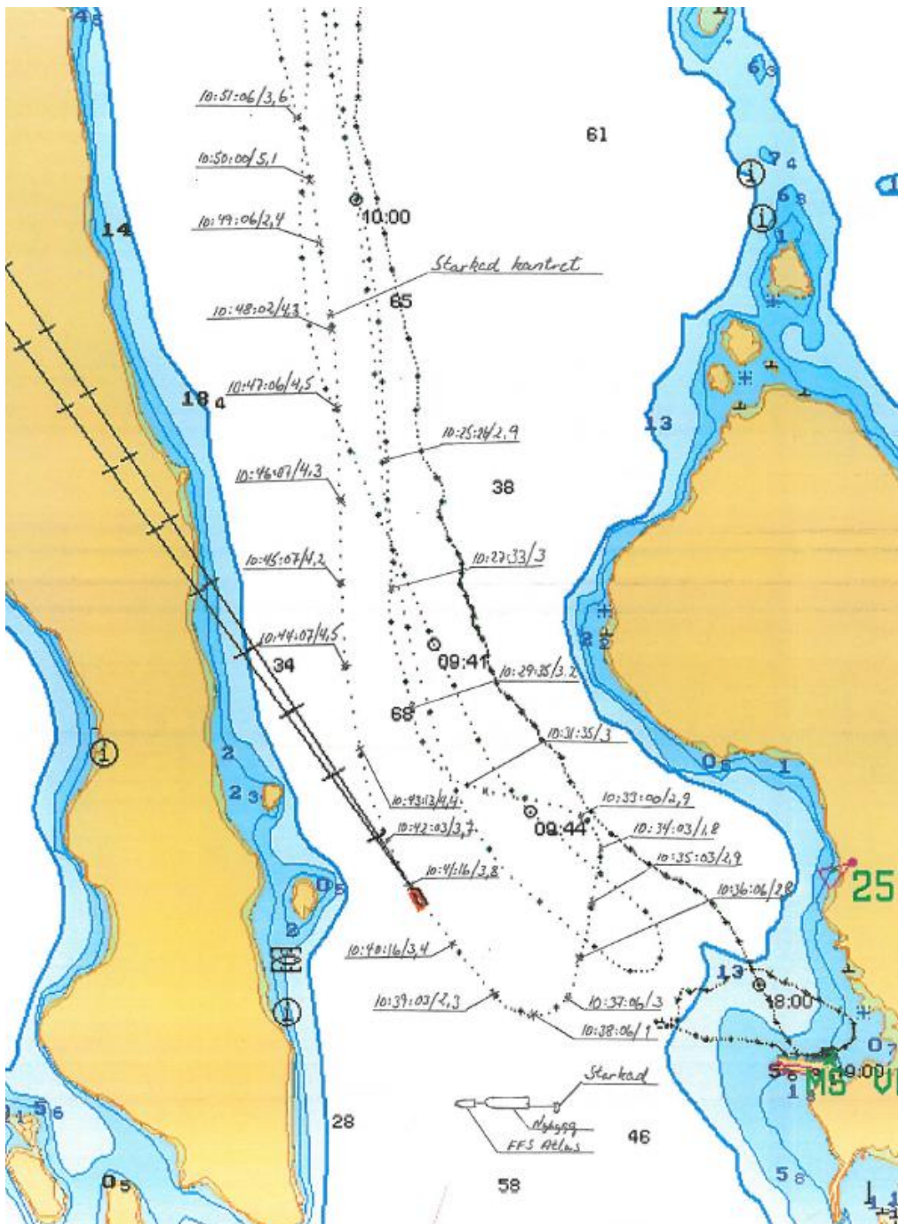
Figur 3: Slepestrek fra FFS Atlas' kartplotter påført klokkeslett og hastighet i h.h.t. AIS-informasjon samt Starkads kantringsposisjon. De tre fartøyene er tegnet inn i kartets skala nederst i bildet. Slepestrek merket 09:44 er den «første runden» FFS Atlas m/slep foretok sydover mot FMVs kai. Slepestrek merket 18:00 viser FFS Atlas' manøvrering utenfor- og anløp til FMVs kai på kvelden ulykkesdagen. Kilde: FFS Atlas/Kystverket/SHT
