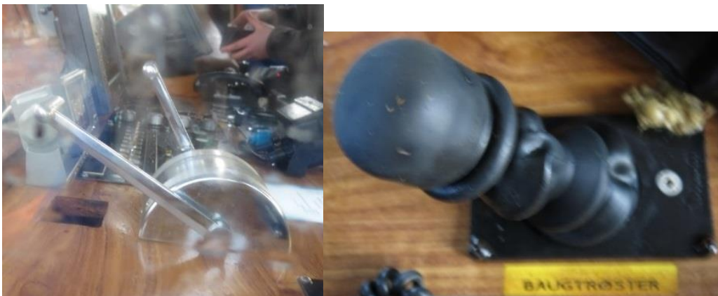
Figur 18: Hendler for pådrag og propellstigning til venstre. Til høyre: Hendel for sidepropell forut (baugthruster). Foto: SHT
