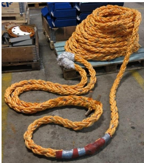
Figur 20: Slepetrossen som ble anvendt ved ulykken. Foto: SHT
