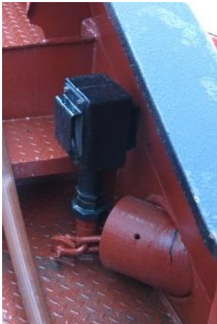
Figur 15: Lufterør med automatisk stengeventil. Foto: SHT
