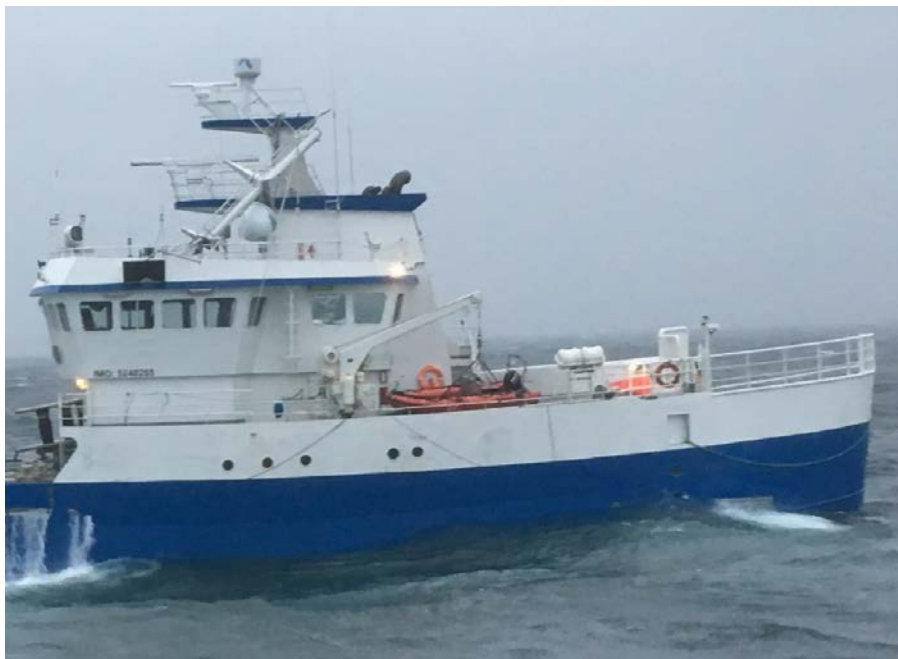
Figur 7: Bildet viser akterskipet mens fartøyet fortsatt er flytende. Aktermasten har brukket, men ingen synlige skader på selve skroget. Kilde: Gularøy
