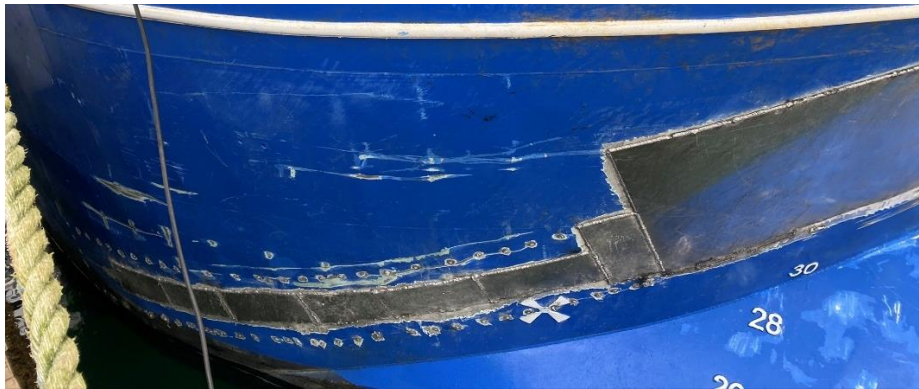
Figur 5: Riftene ble sveiset igjen med aluminiumsplater. Foto: SHK
