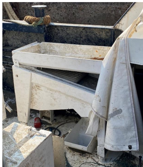
Figur 8: Sollemaskinen med åpen luke under. Foto: Sjøfartsdirektoratet
