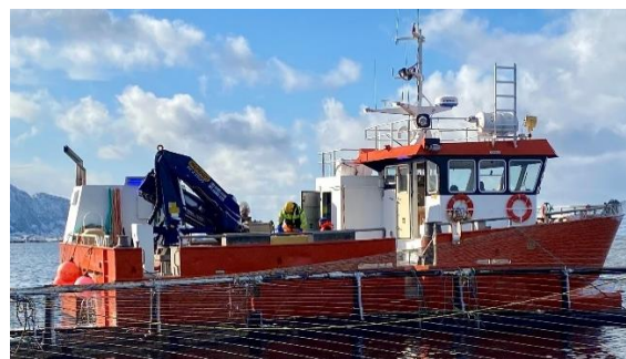
Figur 4: MS Vardskjær II. Katamaranen er bygd i aluminium med dekk for last og utrustet med kran. Arbeidsbåten er 13,34 meter lang og 7,00 m bred. Foto: Lovundlaks AS
