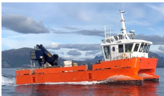
Figur 3: MS Lunderøy. Katamaranen er bygd i aluminium med dekk for last og utrustet med kran. Den er 14,99 m lang og 8,00 m bred. Foto: Lovundlaks AS
