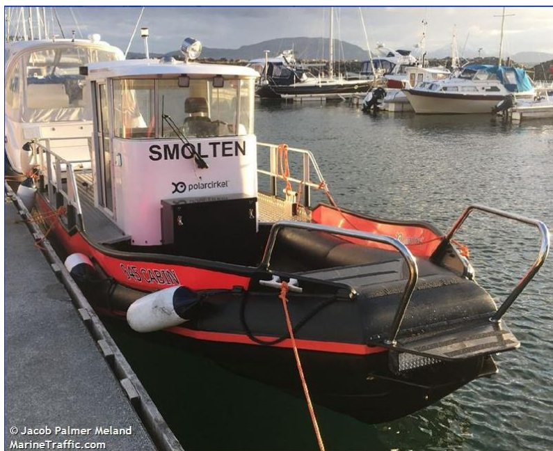
Figur 2: Arbeidsbåten Smolten. Båten er av type Polarirkel 28 fot med førerhus og innenbordsmotor. Foto: Privat
