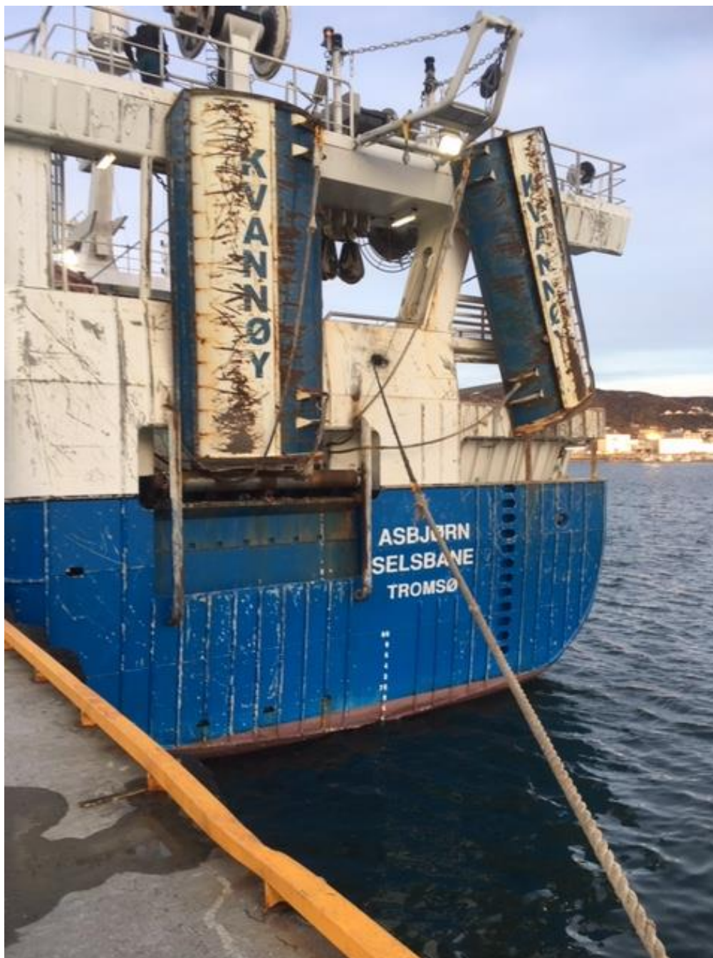
Figur 3: Tråldørene som var i bruk. Babord tråldør er her slakka av i sikringskjettingane. Styrbord tråldør heng framleis stramt frå styrbord trålwire rett over området akterut der ulukka hende. Foto: SHK
