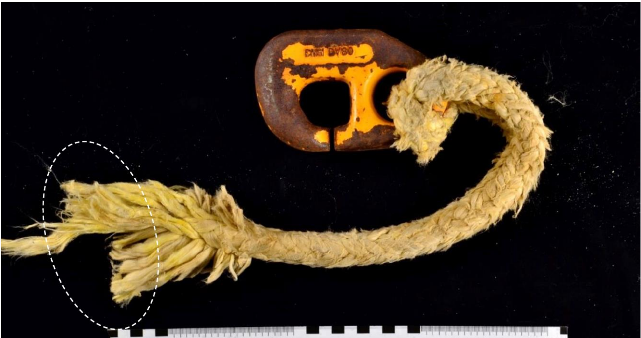
Figur 11: Bruddet som var i enden av spleisen, ca. 0,5 meter fra enden med kroken. Foto: DNV
