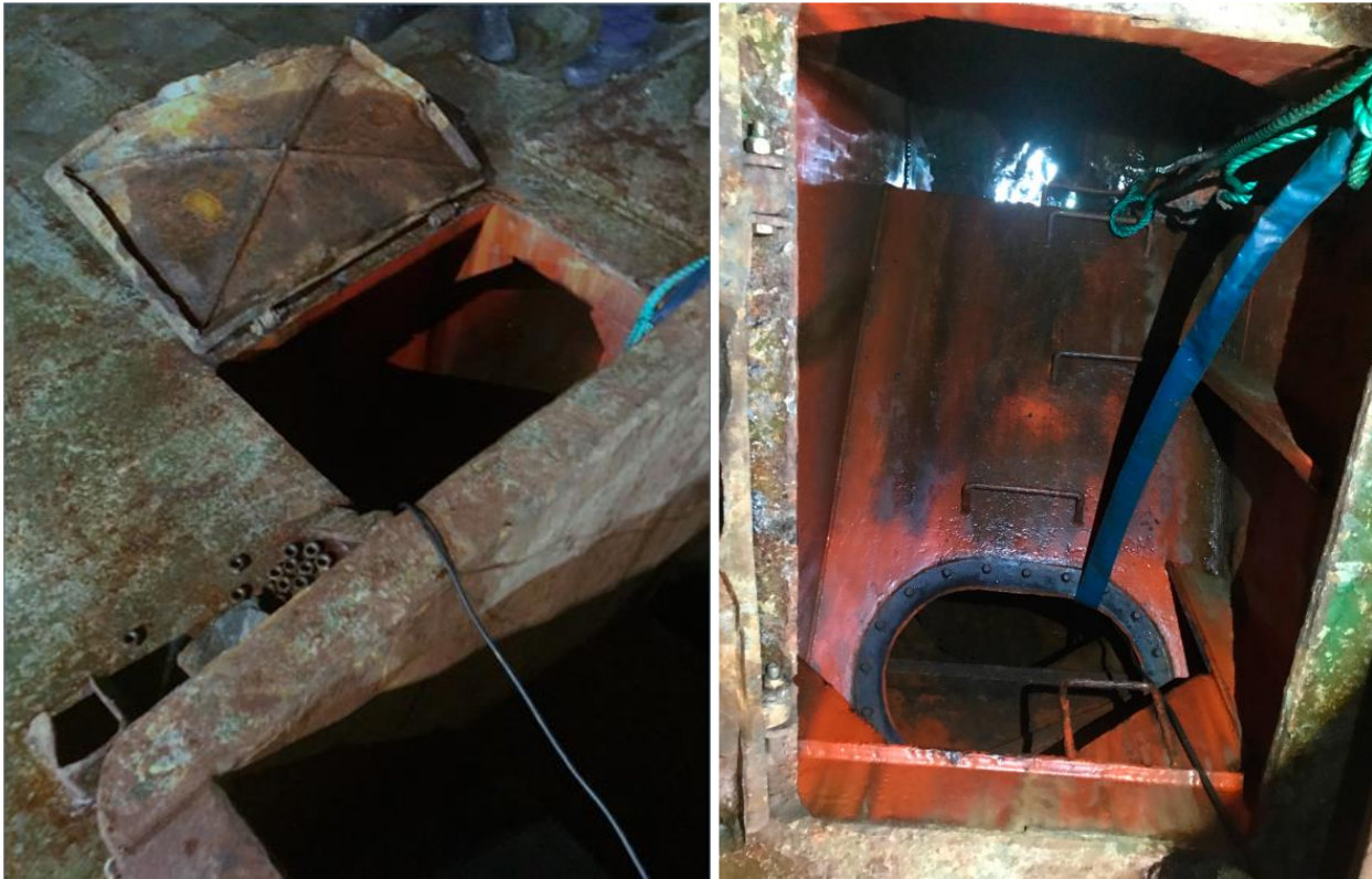
Figur 3: Bildet til venstre viser luka fra utvendig dekk, ved karmen til lasterommet, og ned til babord kofferdam. Bildet til høyre viser mannhullet inn til babord aktre flytetank og slangen som ble benyttet til å pumpe vannet ut fra tanken gjennom kofferdammen og ut i sjøen. Den sorte strømledningen til lensepumpe kan ses på begge bildene. Foto: Politiet
