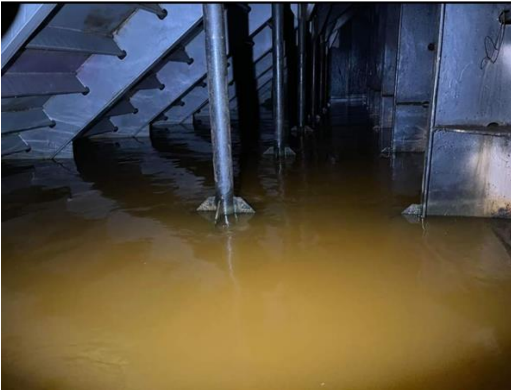
Figur 4: Det ene av de to bildene som ble sendt til maskinansvarlig rundt kl. 16 viser vannstanden i babord aktre flytetank rundt kl. 1300. Foto: Entreprenøren
