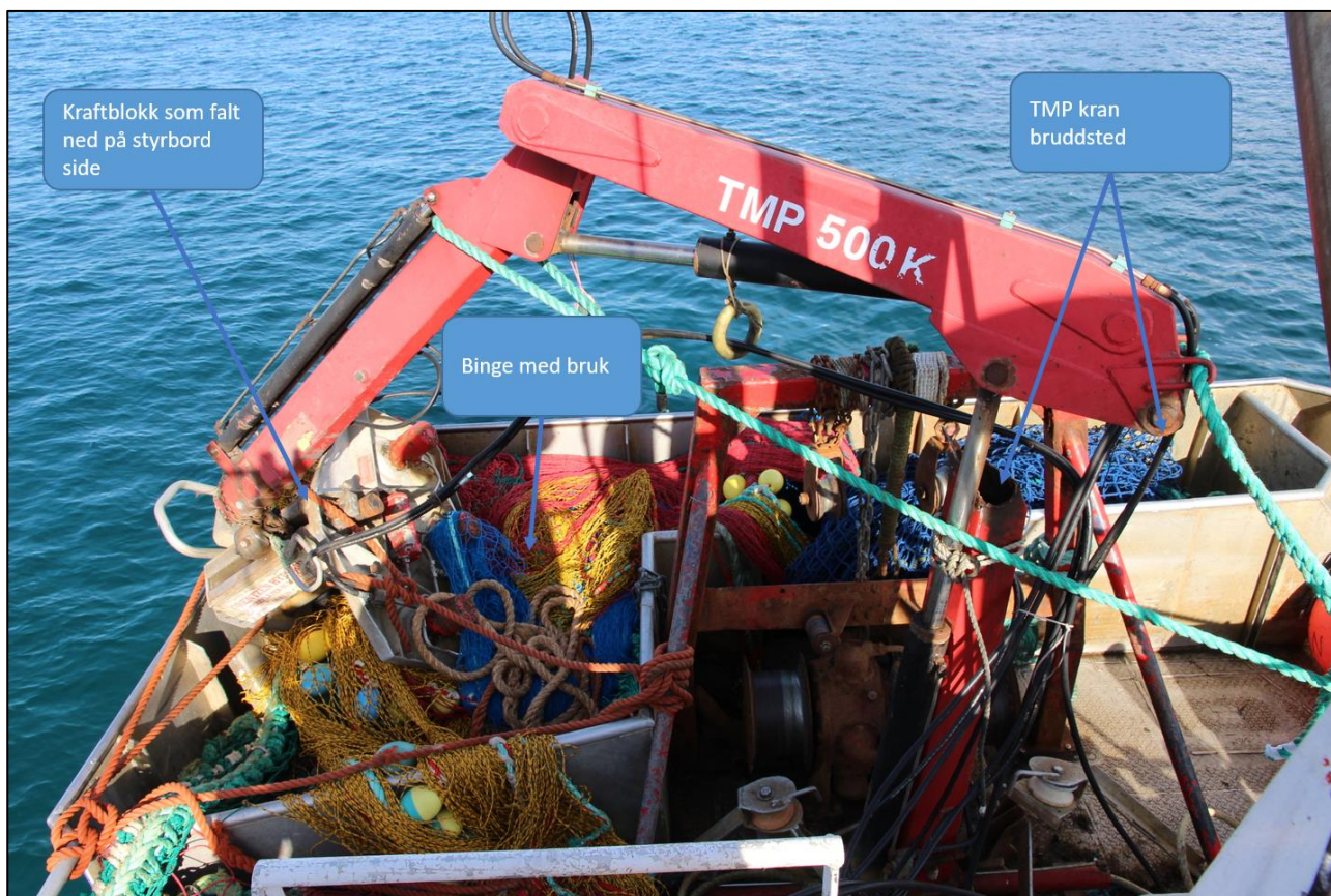
Figur 4: TMP Kran med kraftblokk. Foto: Kystvakta. Påtegninger: SHK
