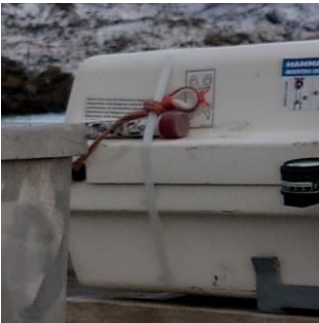
Figur 17: Utløserlinen som ikke er festet til krybben. Utsnitt av foto. Foto: Elektroinstallatør
