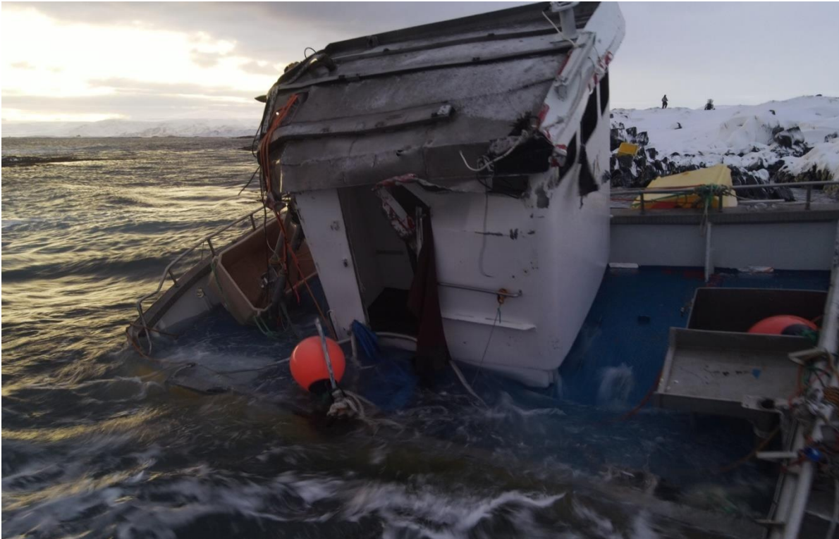
Figur 9: Det var store skader på blant annet styrhuset. Foto: Andreas Ingilæ
