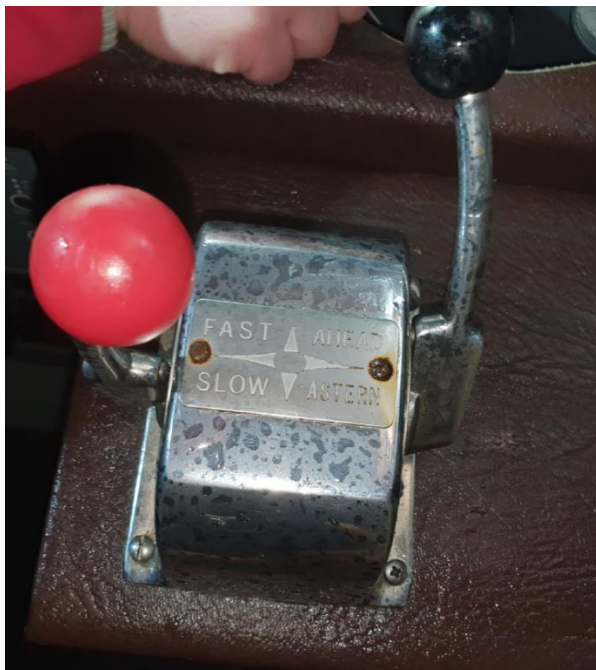
Figur 11: Hendlene viser at fartøyet hadde pådrag fremover. Foto: Politiet
