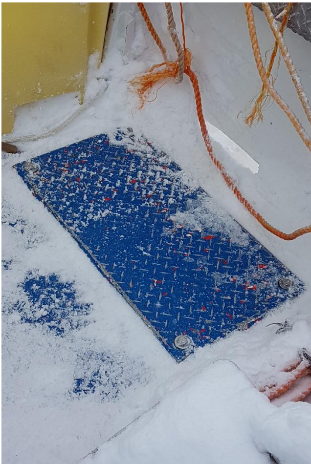
Figur 15: Babord flushluke var lukket under hendelsen. Foto: SHK
