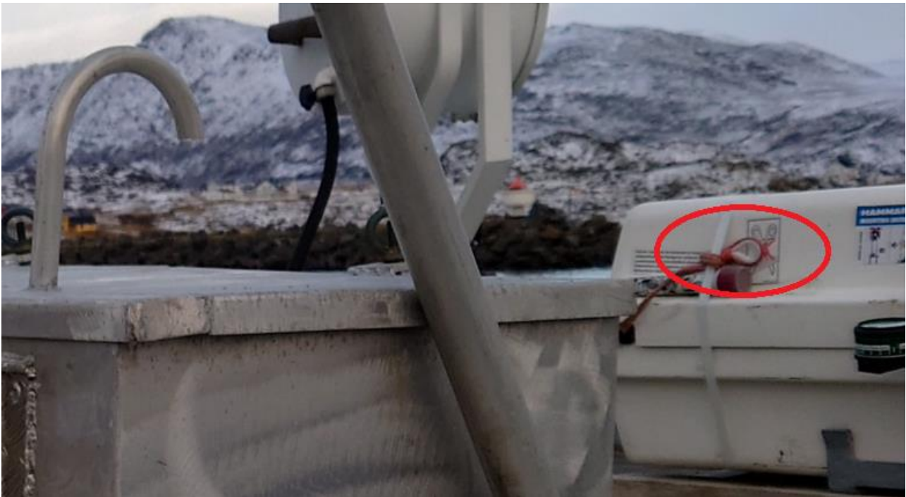
Figur 28: Redningsflåte. Rød ring indikerer tau som skulle ha vært festet i krybben for oppblåsing av flåten. Foto: Elektroinstallatør
