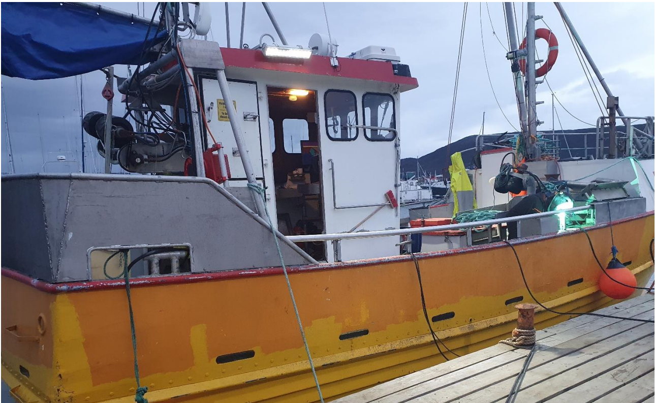
Figur 14: Det var seks lenseporter på styrbord side. Foto: Verksted
