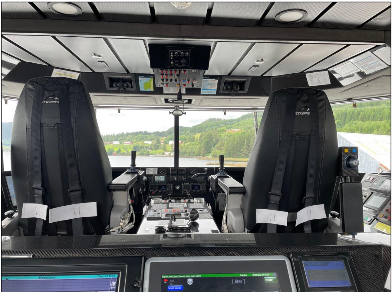
Figur 2: Broen på Tyrhaug sett fra posisjonen til maskinsjefen. Foran er styrbord og babord navigatørposisjon. Bilde: SHK
