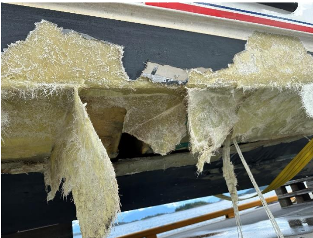
Figur 7: Oversikt over skadeområdet sett fra akter. Foto: SHK
