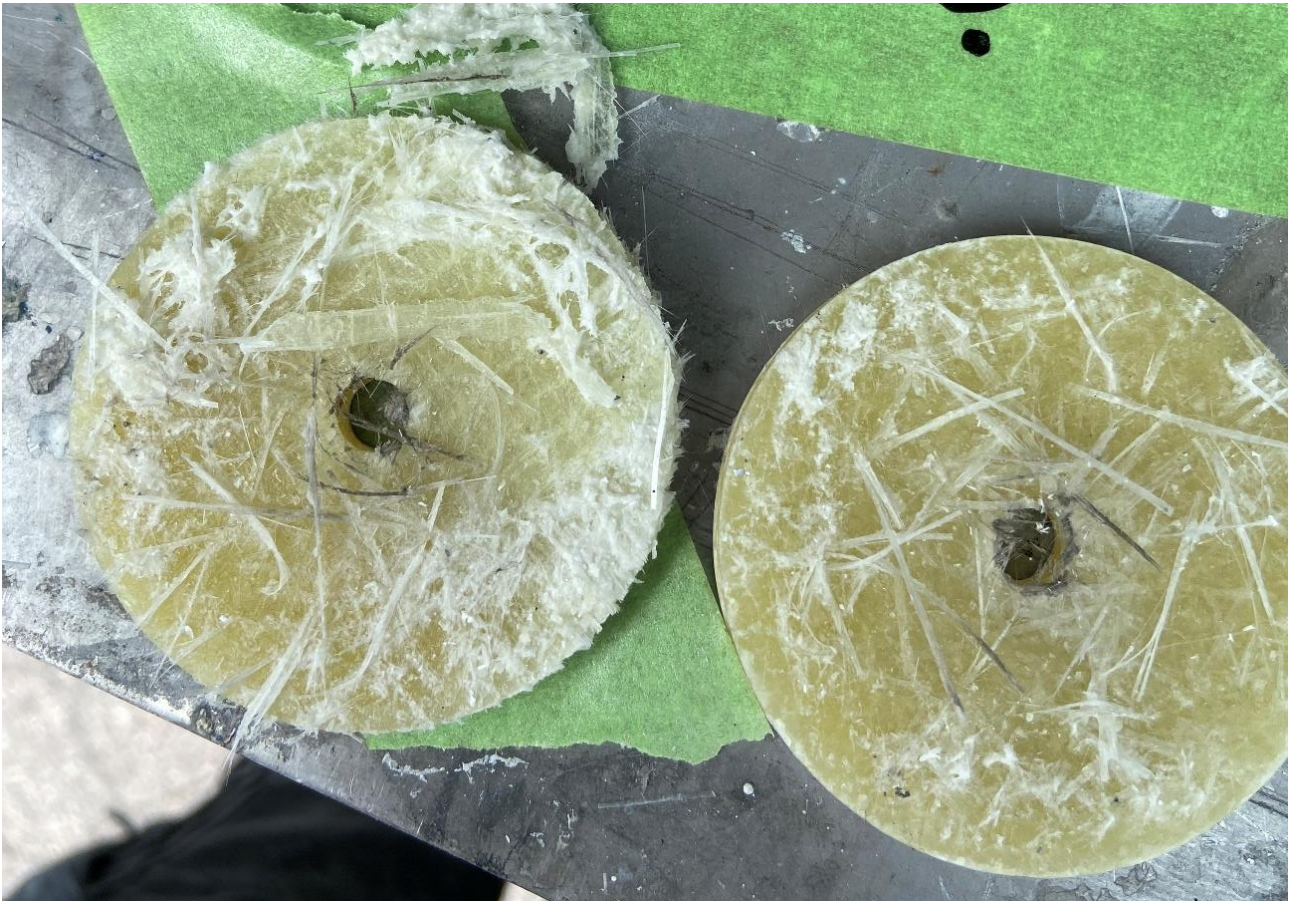
Figur 19: Kjerneborprøver viser at det er delaminering mellom laminatene samt at det er glassfiberstøv mellom laminatlagene. Prøve 2 på styrbord side. Foto: Konsulenten
