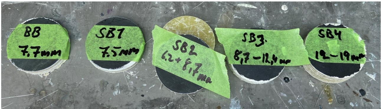
Figur 20: Oversikt over kjerneprøver som er tatt fra skroget, der prøve 2 på styrbord side vises i midten. Foto: Konsulenten
