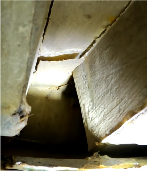
Figur 9: Sprekker i innredningen observert gjennom hullet i skroget Foto: SHK
