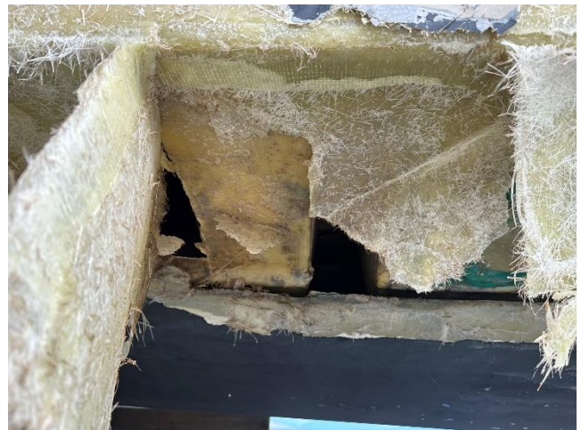
Figur 8: Nærbilde av skadeområdet viser hull inn i fartøyet. Foto: SHK
