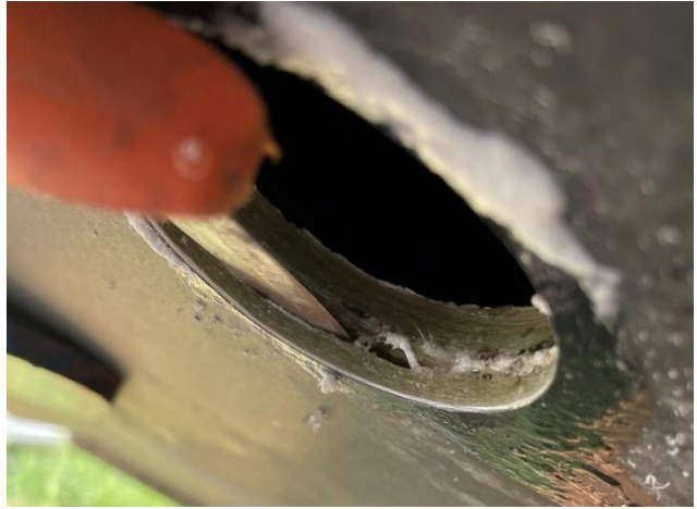
Figur 18: Kjerneborprøver viser at det er delaminering mellom laminatene. Prøve 2 på styrbord side. Foto: Konsulenten
