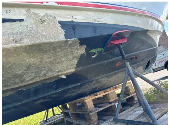
Figur 23: Kjerneprøve 4 på styrbord side. Foto: SHK
