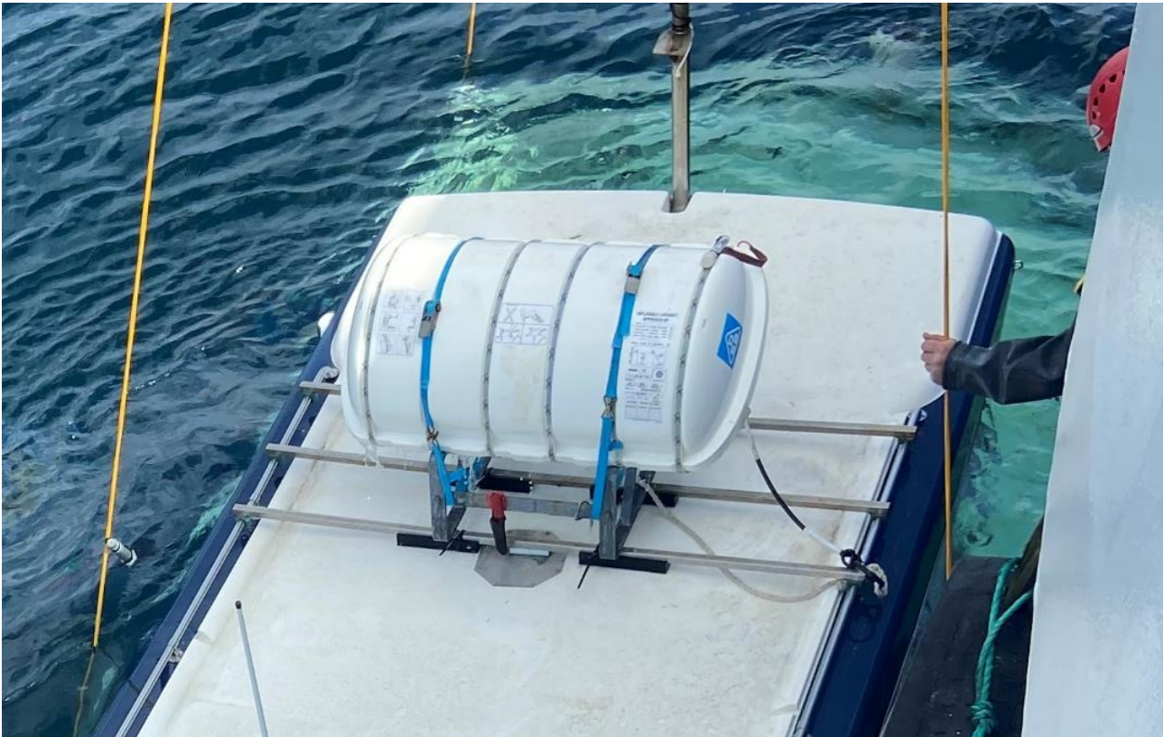
Figur 13: Flåten som var stropet fast til styrehuset. Foto: SHK
