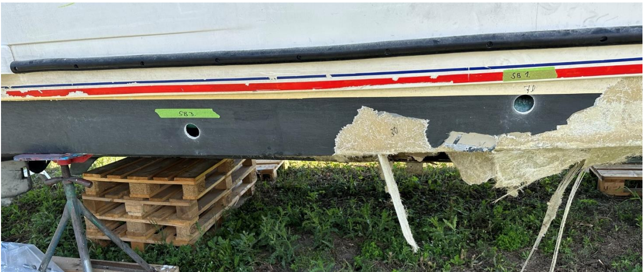
Figur 21: Kjerneprøve 3 og 1 på styrbord side. Prøven på babord side var tatt tilsvarende sted som prøve 1 på styrbord side. Foto: SHK
